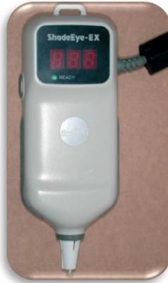
Figura 53 Terminal con lector y pantalla del colorímetro Shaded Ex Eye.
