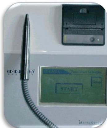
Figura 54 Terminal y unidad central con pantalla e impresora del colorímetro Identa Color II.
