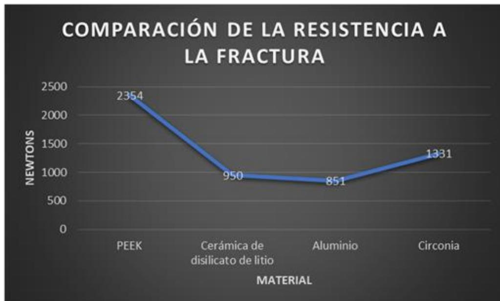
Fig. 5 Comparación de la resistencia a la fractura.
