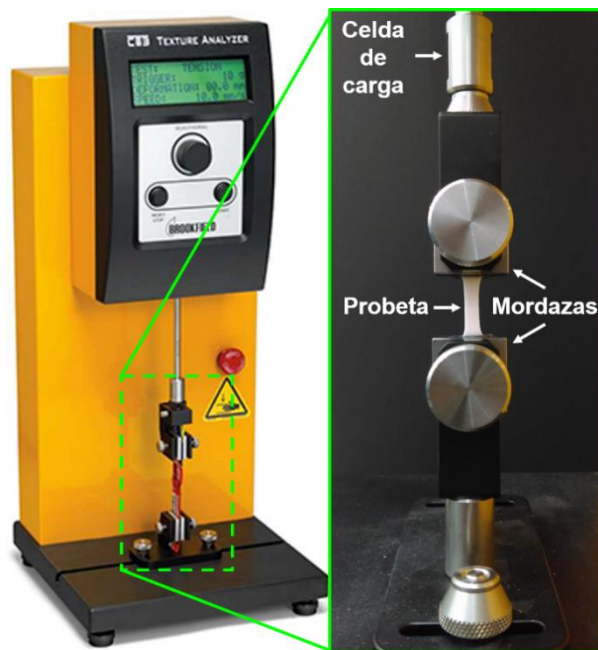
Figura 18. Texturómetro empleado para los ensayos de tensión uniaxial y algunos de sus componentes para el montaje de la probeta (membrana C100) hidratada con PBS.
