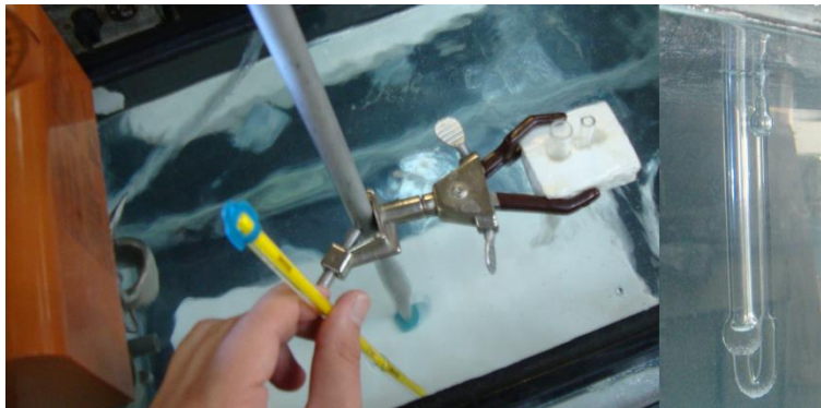
Figura 16. Montaje de la viscosimetría capilar para determinar el peso molecular promedio del quitosán.
