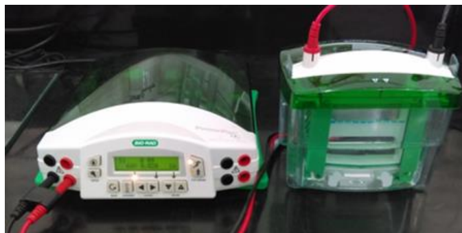
Figura 13. Equipo de electroforesis empleado para conocer la pureza de la colágena tipo I. Fuente de corriente continua (izquierda) y cámara de electroforesis (derecha).
