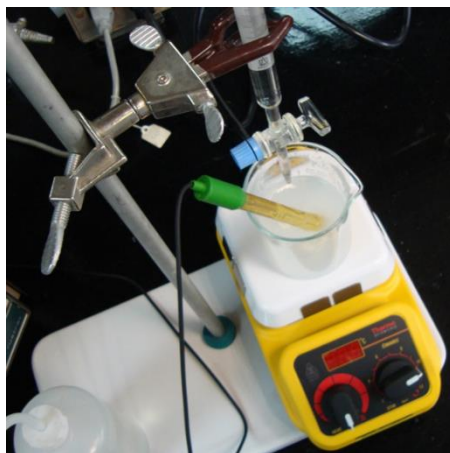
Figura 15. Montaje de la titulación potenciométrica para determinar el grado de desacetilación del quitosán.
