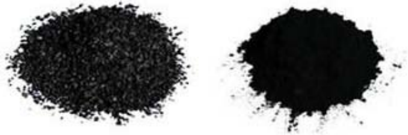
Figura 2.5. Tipos de carbón activado granular y en polvo.
