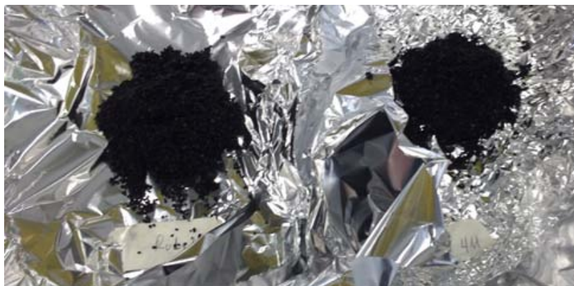
Figura 4.14. Carbón activado CADI, 1M dopado con [\text{RuL}^1\text{Cl}(\text{PPh}_3)]\text{Cl}
