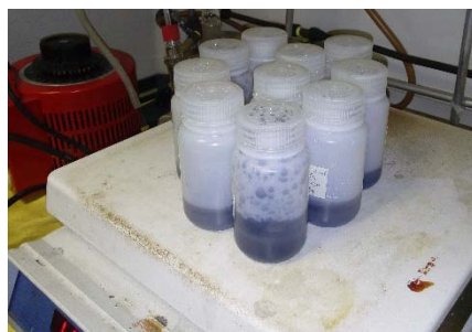
Figura 4.13 Proceso de dopado del Carbón CADI 4M con [\text{RuL}^1\text{Cl}(\text{PPh}_3)]\text{Cl}
