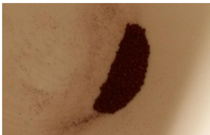
Figura 12. Glioximato de Pt/Pd incinerado
