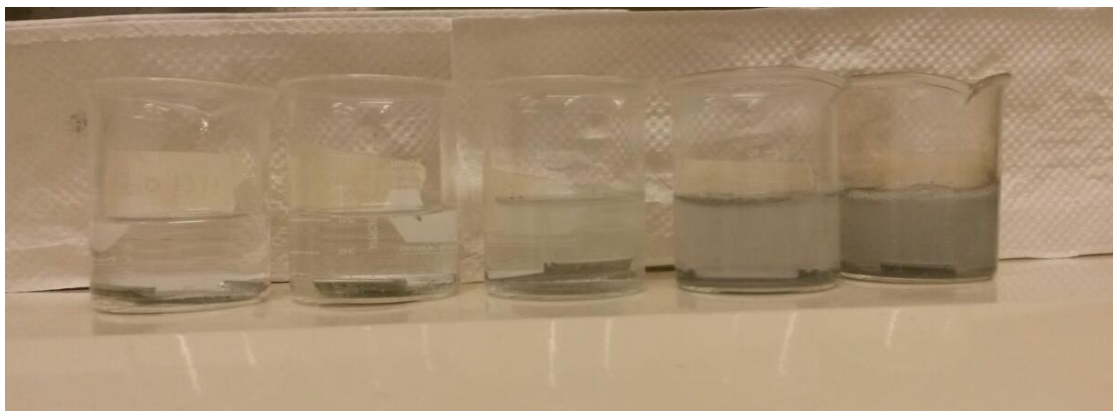
Figura 20. Aluminio disuelto en ácido clorhídrico a concentraciones de 0.5, 1, 1.5, 2, 2.5M respectivamente y T=55°C
