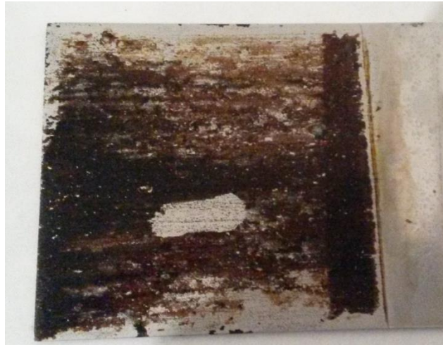
Figura 54. Electrodepósito del agua regia
