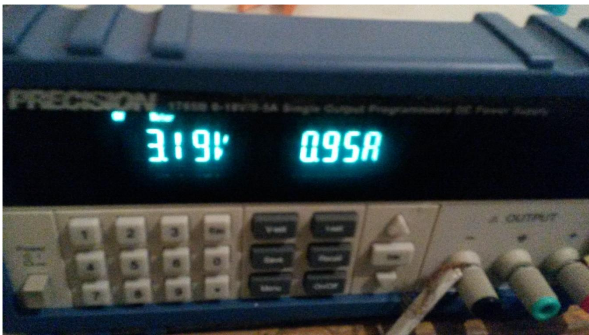
Figura 8. Potencial y corriente usados en la solución de ácido sulfúrico
