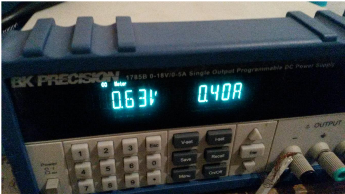
Figura 18. Fuente de poder mientras se realiza el electrodepósito de agua regia
