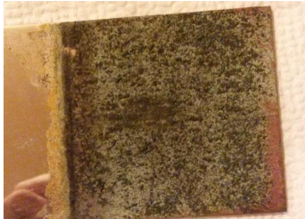
Figura 32. Polvos en el ánodo del electrodepósito de cobre
