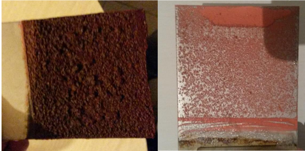
Figura 51. Electrodepósitos de cobre
