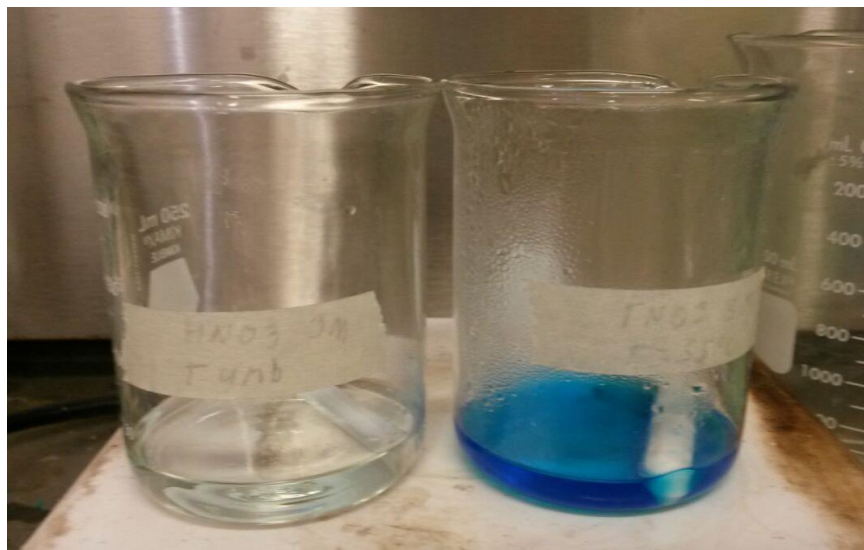
Figura 26. Prueba \text{HNO}_3 3M con cobre (temperatura ambiente y 55^\circ\text{C} )
