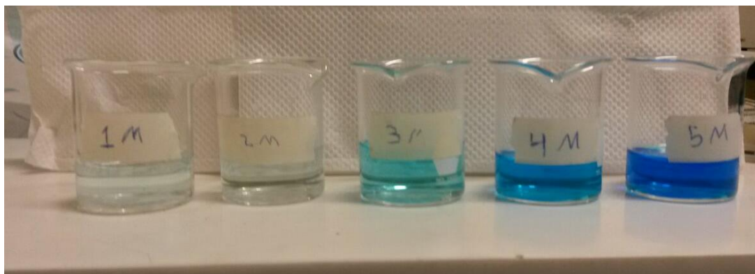
Figura 25. Prueba \text{HNO}_3 con cobre a distintas concentraciones (Temperatura ambiente)
