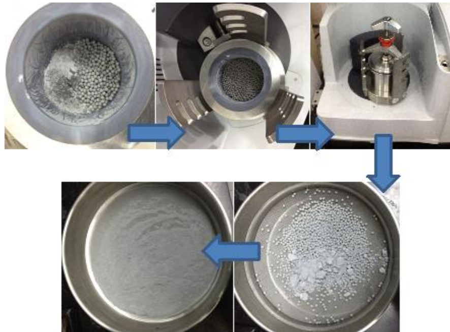
Figura 9. Preparación de las mezclas de polvo, desde la molienda hasta el tamizado. Molino Retsch PM 100 GlenMills Inc.
