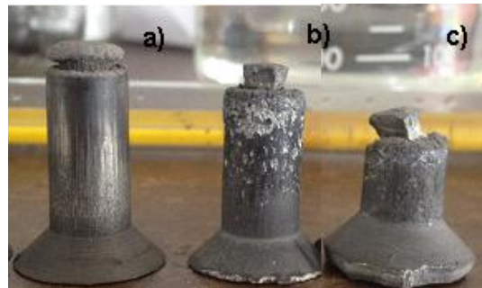
Figura 14. Fotografías de a) probeta de Ti extruidas a 1000°C, b) compuesto de Ti-HA 90-10 a 1400°C y c) de Ti-HA 80-20 a 1400°C.
