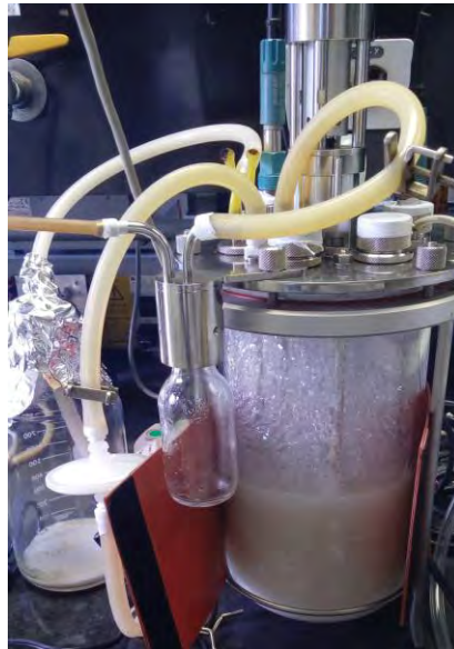
Figura 9.30 Cultivo de la cepa IMP-K en reactor tanque agitado con aceite de soya como sustrato, con aireación de 1000 mL/min donde hubo formación de espuma.
