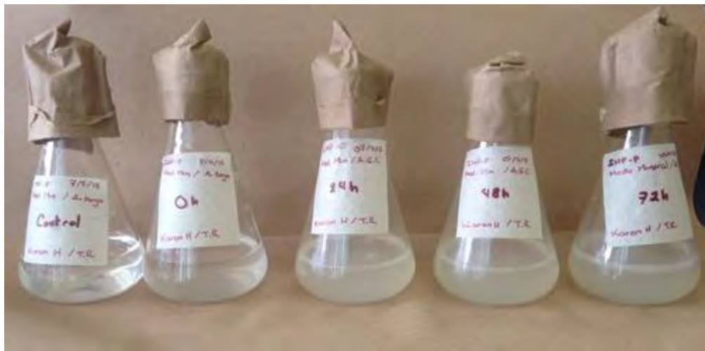
Figura 9.4 Cultivos de la cepa IMP-K en medio mineral y aceite de soya como sustrato a diferentes tiempos de incubación.
