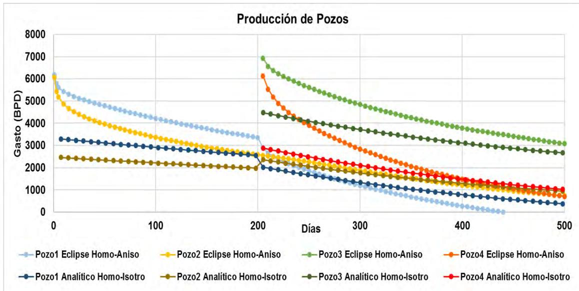
Figura 4.36 Gráfica de Comparación del Modelo Analítico del Medio Homogéneo-Isotrópico ( $k_x = k_y = 34$  md), con el Modelo de Simulación Numérica del Medio Homogéneo-Anisotrópico ( $k_x = 34$  md;  $k_y = 100$  md)
