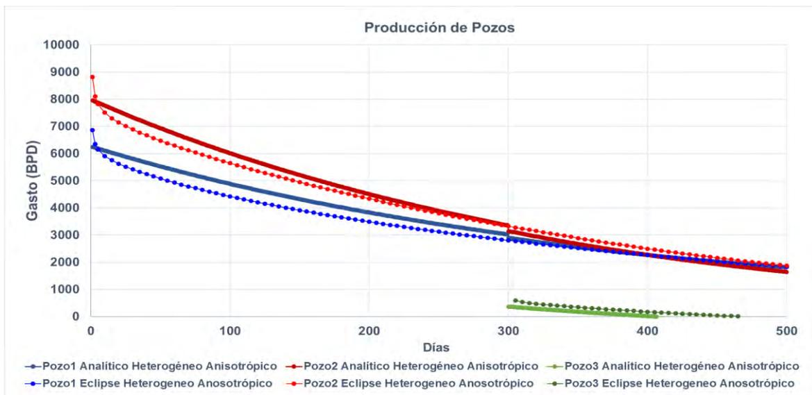
Figura 4.39 Gráfica del Medio Heterogéneo-Anisotrópico ( $k_x = [0:100]$  md;  $k_y = 34$  md) del Caso 5, produciendo 4 pozos, a diferentes tiempos,  $N=20$ , comparando el Modelo Analítico con el Simulador Numérico
