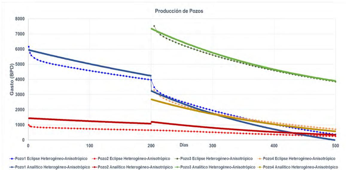
Figura 4.30 Gráfica del Medio Heterogéneo-Anisotrópico ( $k_x = [0:100]$  md;  $k_y = 34$  md) del Caso 4, produciendo 4 pozos a diferentes tiempos,  $N=20$ , comparando el modelo analítico con el simulador eclipse
