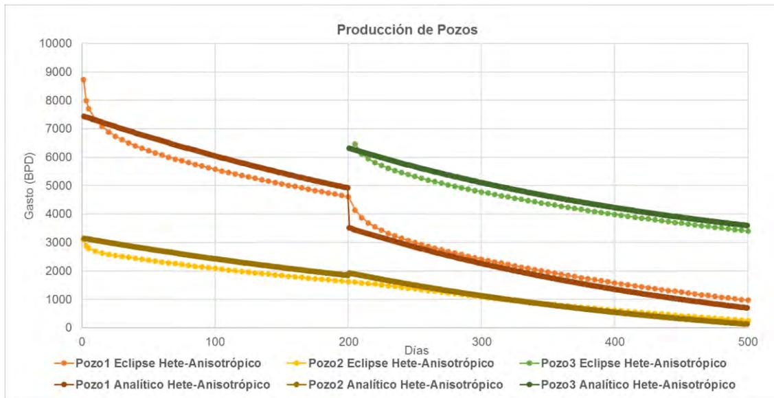
Figura 4.21 Gráfica del Medio Heterogéneo-Anisotrópico del Caso 3, produciendo 4 pozos, a diferentes tiempos,  $N=20$ , comparando el Modelo Analítico con el Simulador Numérico
