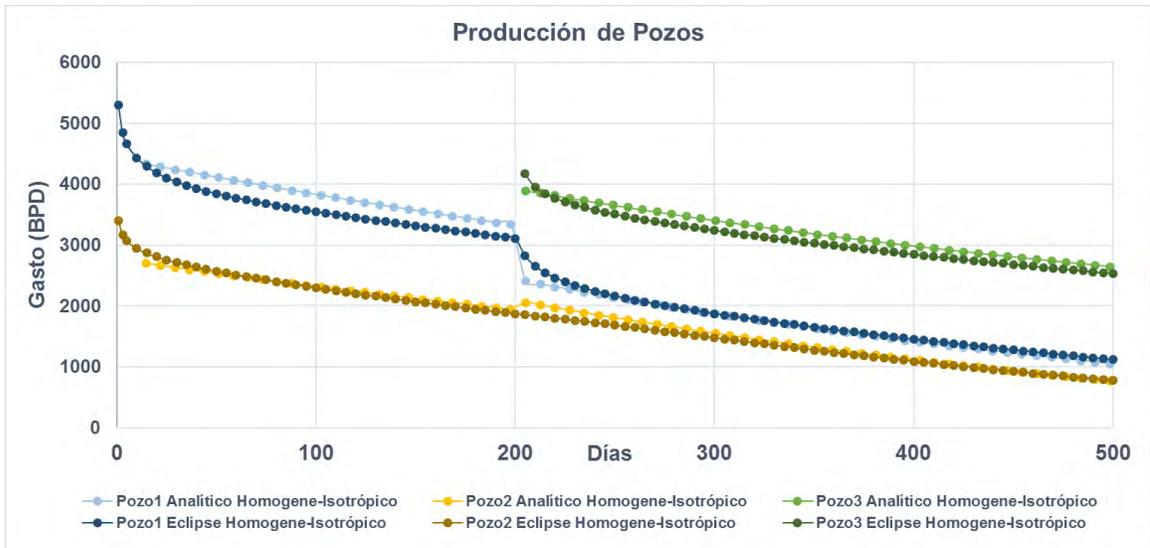
Figura 4.24 Gráfica del Caso 3, Medio Homogéneo-Isotrópico ( $k_x = k_y = 34 \text{ md}$ ), produciendo 3 pozos a diferentes tiempos, comparando el modelo analítico con el simulador eclipse
