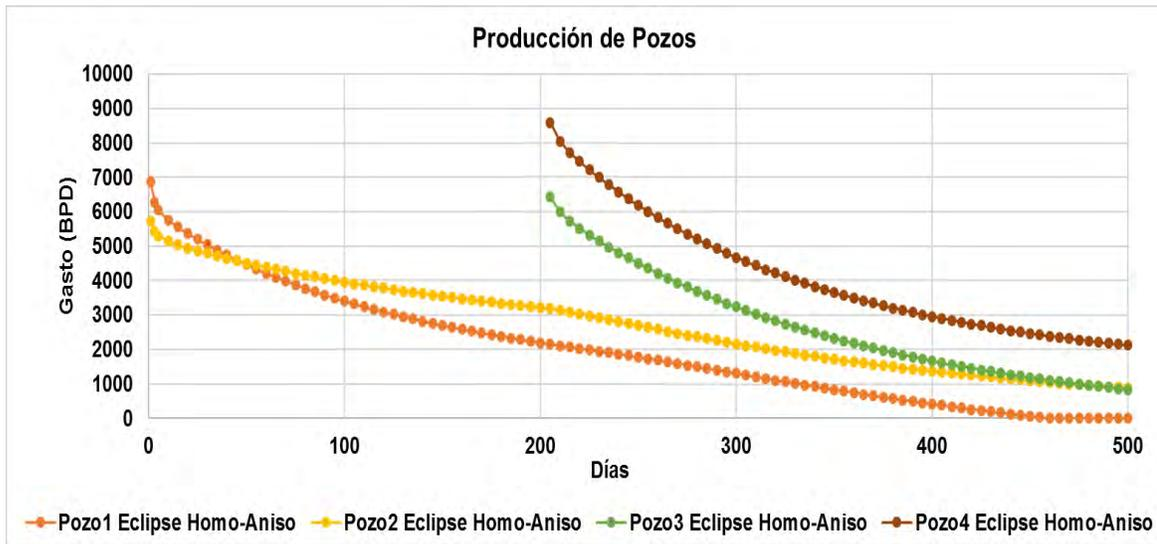
Figura 4.10 Gráfica del Medio Homogéneo-Anisotrópico ( $k_x = 34$  md ;  $k_y = 100$  md ), generada con el Simulador Numérico, con 4 pozos productores de petróleo
