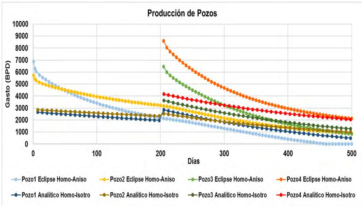
Figura 4.18 Gráfica de Comparación del Modelo Analítico del Medio Homogéneo-Isotrópico ( $k_x = k_y = 34$  md), con el Modelo de Simulación Numérica del Medio Homogéneo-Anisotrópico ( $k_x = 34$  md ;  $k_y = 100$  md)
