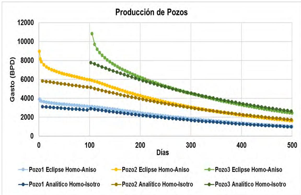
Figura 4.9 Gráfica de Comparación del Modelo Analítico del Medio Homogéneo-Isotrópico ( $k_x = k_y = 34$  md), con el Modelo de Simulación Numérica del Medio Homogéneo-Anisotrópico ( $k_x = 34$  md;  $k_y = 50$  md)
