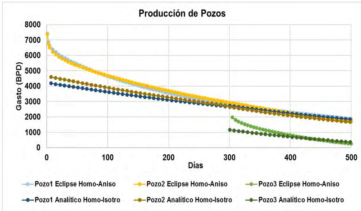
Figura 4.44 Gráfica de Comparación del Modelo Analítico, del Medio Homogéneo-Isotrópico ( $k_x = k_y = 34$  md), y el Modelo del Simulador el Medio Homogéneo-Anisotrópico ( $k_x = 34$  md;  $k_y = 68$  md)
