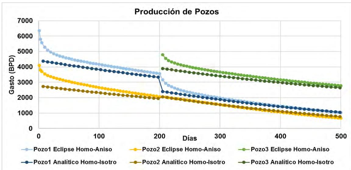
Figura 4.27 Gráfica de Comparación del Modelo Analítico del Medio Homogéneo-Isotrópico ( $k_x = k_y = 34$  md), con el Modelo de Simulación Numérica del Medio Homogéneo-Anisotrópico ( $k_x = 34$  md;  $k_y = 50$  md)
