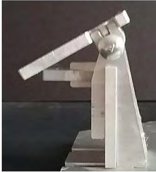
Figura 50. Módulo de horizonte visto de perfil manufacturado en aluminio
