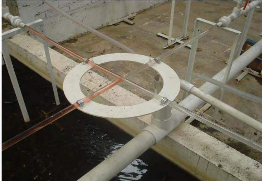
Figura 6. 9 Cruce de acrílico 2, y sin mezcla de flujos (colorante)
