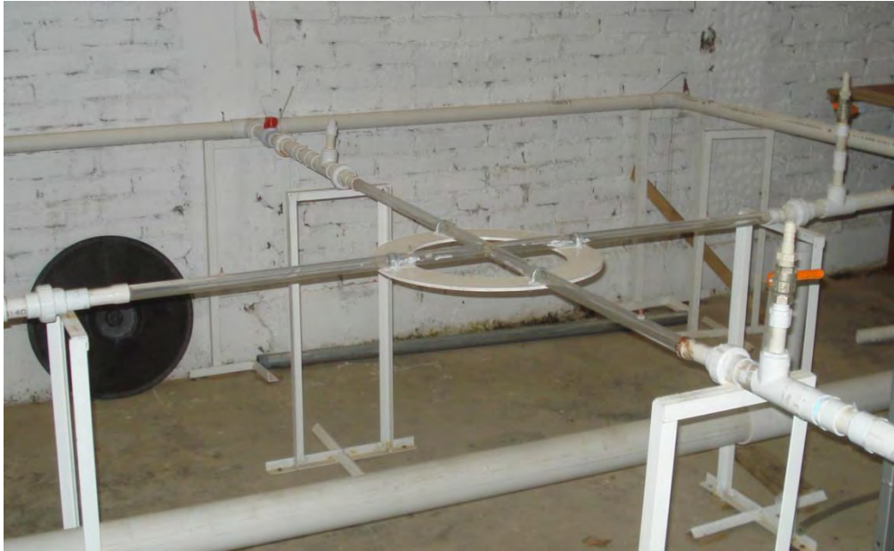
Figura 6. 5 Cruces de acrílico para visualización del flujo
