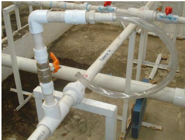
Figura 6. 6 Salidas de agua en el modelo
