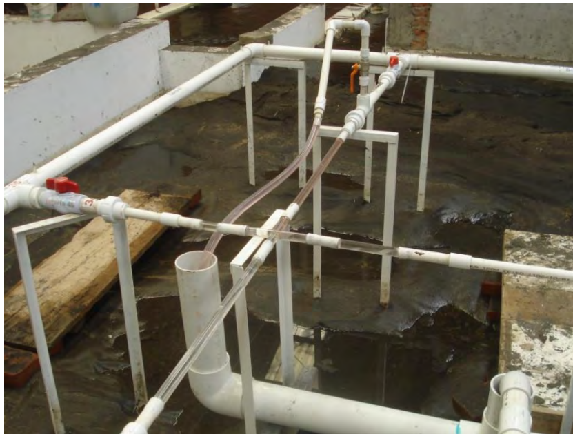
Figura 6. 10 Cruce de acrílico 3, con muy poca mezcla de flujos
