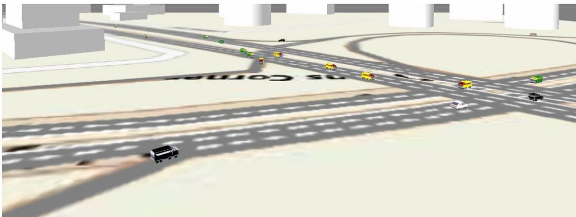
Figura 5.17. Simulación de tráfico de la autopista con la visualización en 3D.<sup>223</sup>
