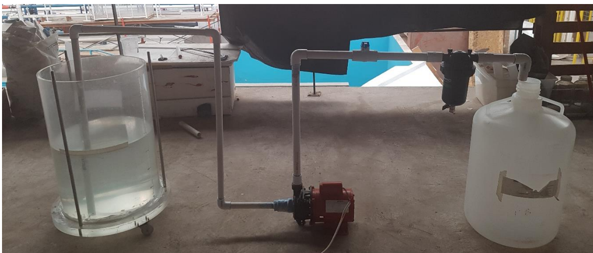
FIGURA 11 SISTEMA DE FILTRACIÓN EMPLEADO EN PRUEBAS DE REMOCIÓN DE HUEVOS DE MELOIDOGYNE ENTEROLOBII
