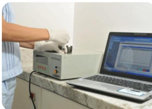
Figura 12. Cromatógrafo de gases.<sup>19</sup>
