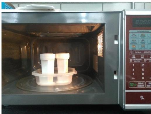
Figura 17 Los vasos Coplin sumergidos en una bandeja con agua y colocados en el microondas.
