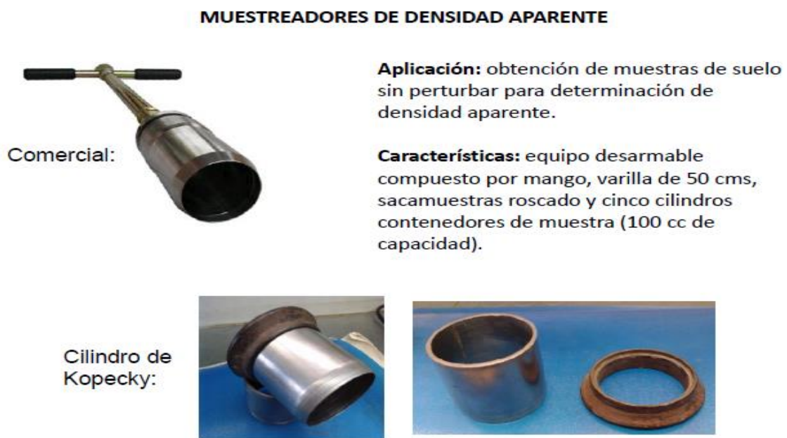
Figura 3. Muestreadores de Densidad Aparente; Fuentes: “Curso de Edafología” en la Universidad de Granada España, Propiedades Físicas de los Suelos, Susana Hang (2014)
