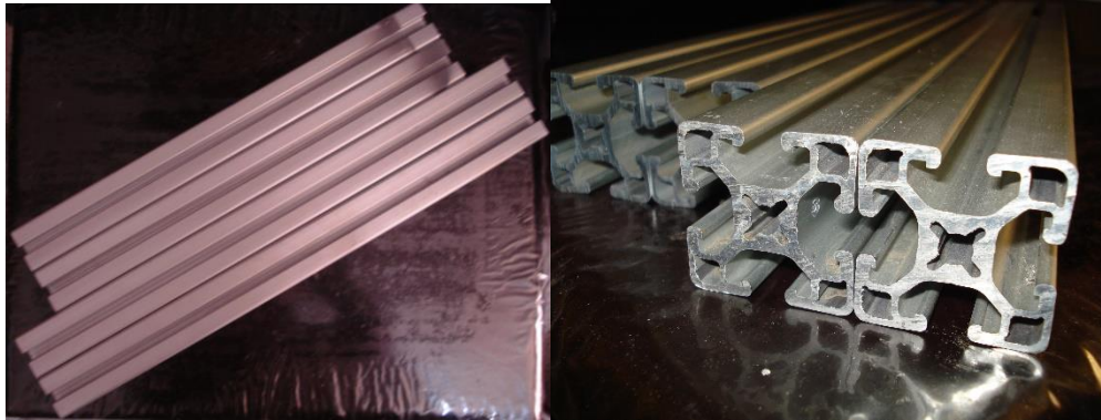
Figura 4.1. Perfiles de aluminio 40x40 mm que conforman la estructura del marco.
