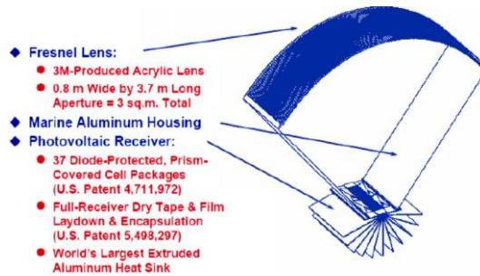
Figura 1.10. Módulo de concentración ENTECH de cuarta generación. [1.4]
