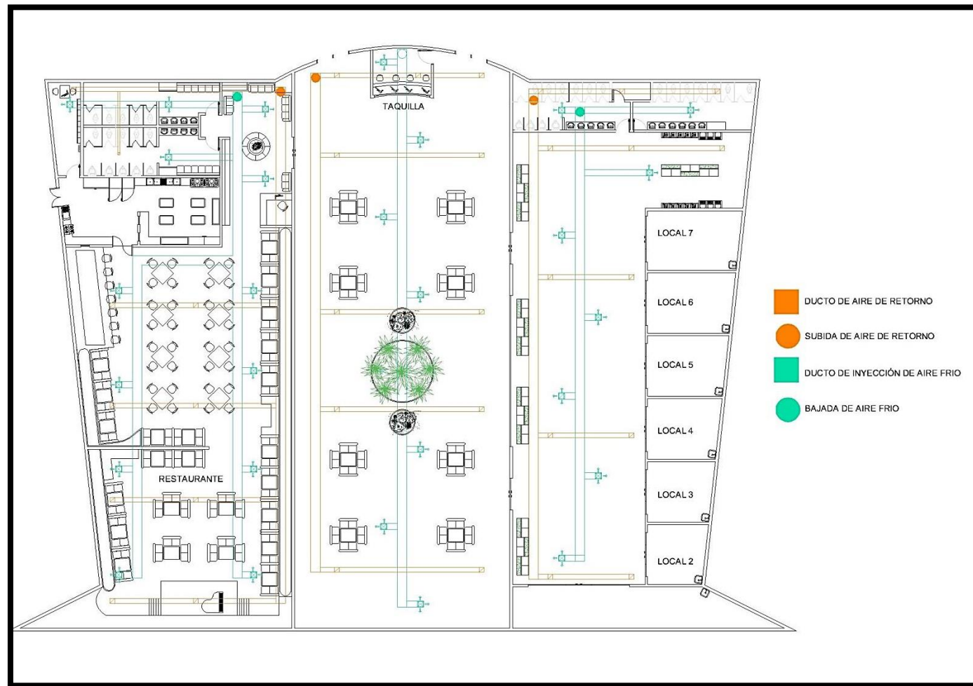
INSTALACIÓN. De aire acondicionado en la primera sección del Acuario.
