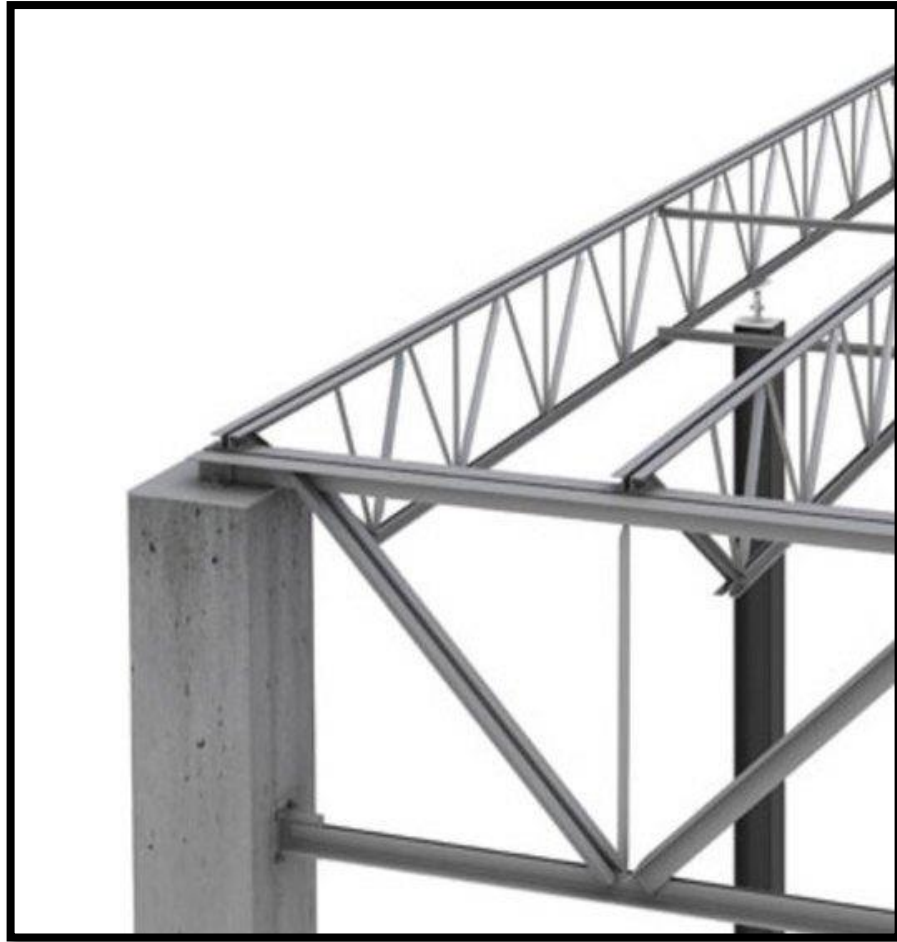
EL Sistema estructural de Alma Abierta, es óptimo, para proyectar grandes claros.
