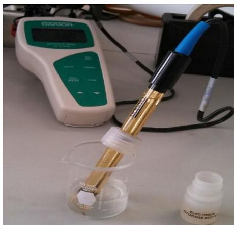
**Figura 15. Potenciómetro**
