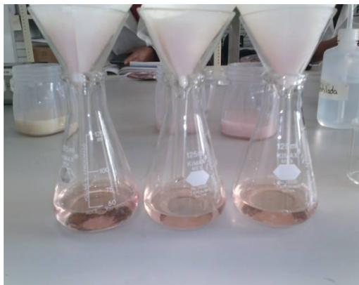
**Figura 17. Filtrado de la muestra**
