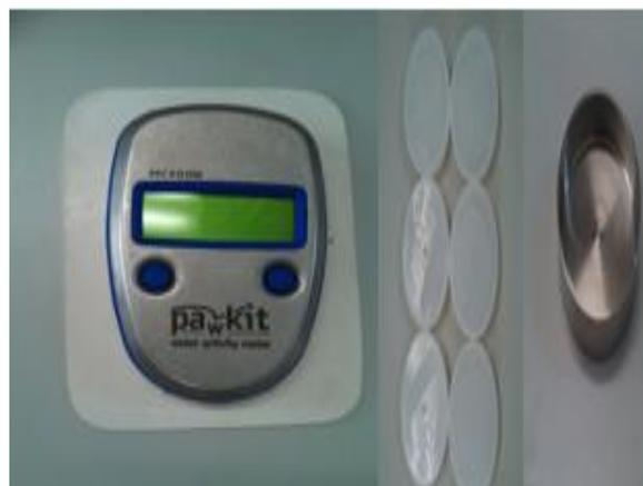
**Figura 14. Higrómetro de punto de rocío**
