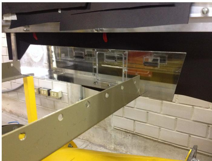
Figura 2.15: Espejo. Dimensiones:  $53 \times 12$  *cm* y espesor de 3 *mm*. Elaboración propia.
