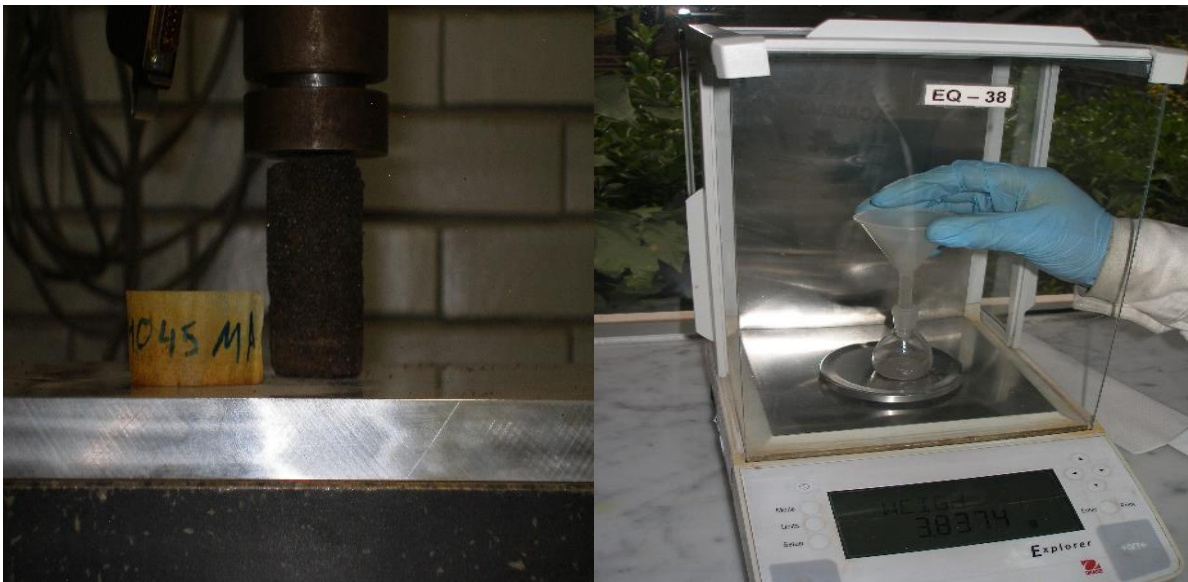
Fotografía 6. Del lado Izquierdo Prueba de resistencia a la compresión. Del lado derecho Determinación de la densidad real por medio del método del picnómetro.
