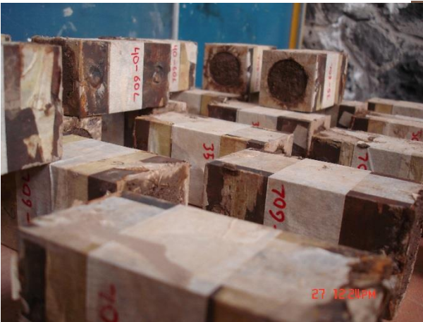
Fotografía 3. Secado de las probetas con y sin molde
