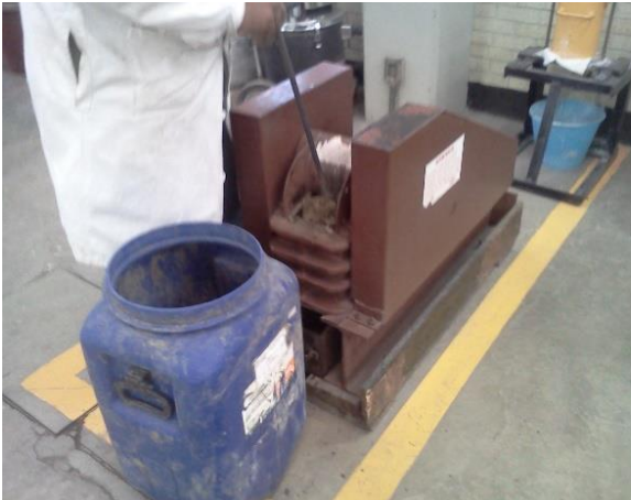
Fotografía 1. Molienda del lodo y arcilla.
