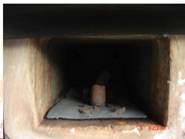
Fotografía 4. Cocido de las probetas, con y sin molde.
