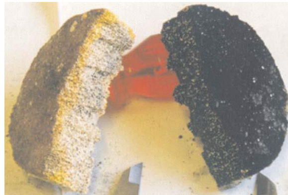
Figura II - 17: Vista de una espuma que contiene el catalizador Cs_4V_2O_7 después del envejecimiento hidrotérmico . Lado izquierdo después de la regeneración por combustión de carbón en el horno a 450 °C. Lado derecho antes de la regeneración. (Scheffer & Colombo, 2005)
