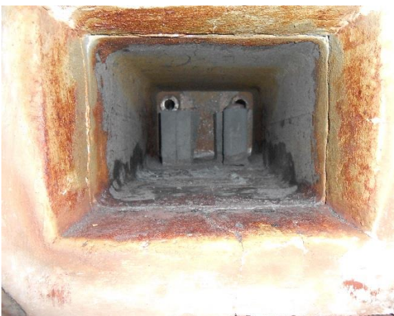
Fotografía 4. Cocido de las probetas, con y sin molde.
