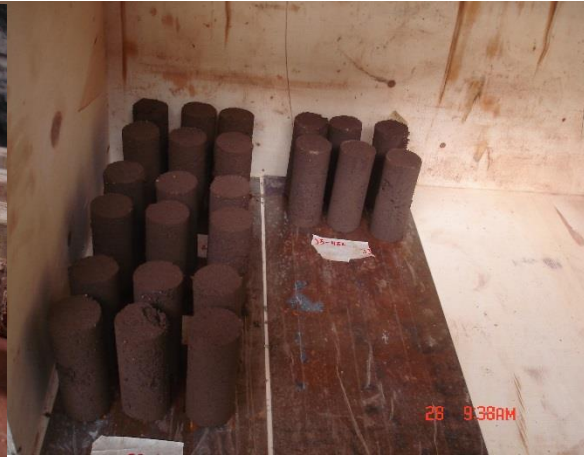
Fotografía 3. Secado de las probetas con y sin molde
