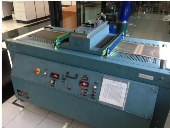
Figura 2. 14: Equipo de curado UV.
