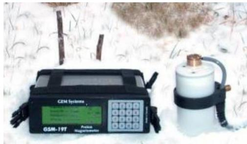
**Figura 3.5** La consola y el sensor del equipo GSM-19TW.
