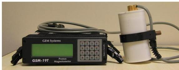
**Figura 3.4** La consola y el sensor del equipo GSM-19T utilizado para la base magnética.
