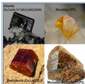
Figura. 3.1. Minerales de donde se obtienen algunos lantánidos, tales como: Bastnaesita, Monacita, Xenotima, Allanita, entre los más comunes.
