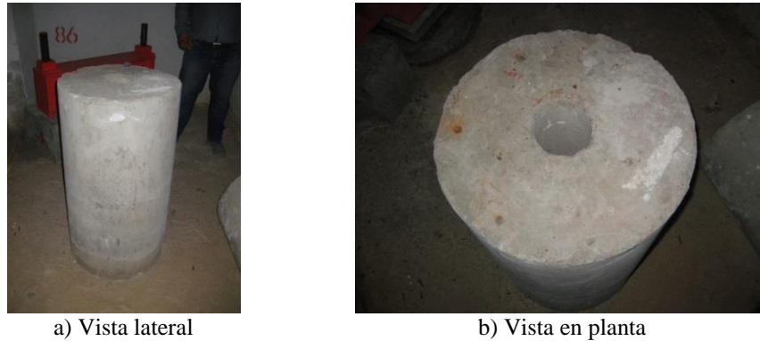
Figura 2.7 Tramo de pilote de 91 cm de altura.
