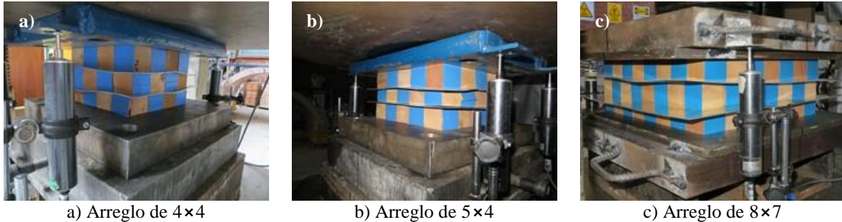
Figura 4.26 Deformación en arreglos de tres niveles de cubos de madera de caobilla.
