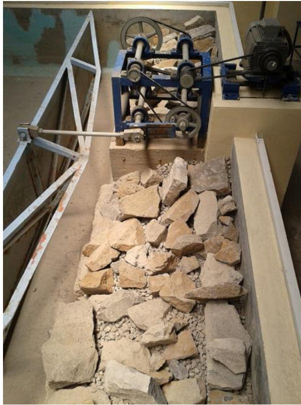
Figura 3.7 Reacomodo que forman el dissipador de energía detrás de la pala generadora de olas
