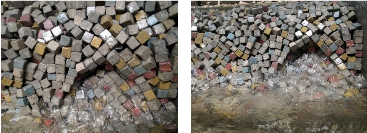
Figura 3.27 Pérdida de piezas cerca de la pared del estanque, cuando se considera la marea de tormenta
