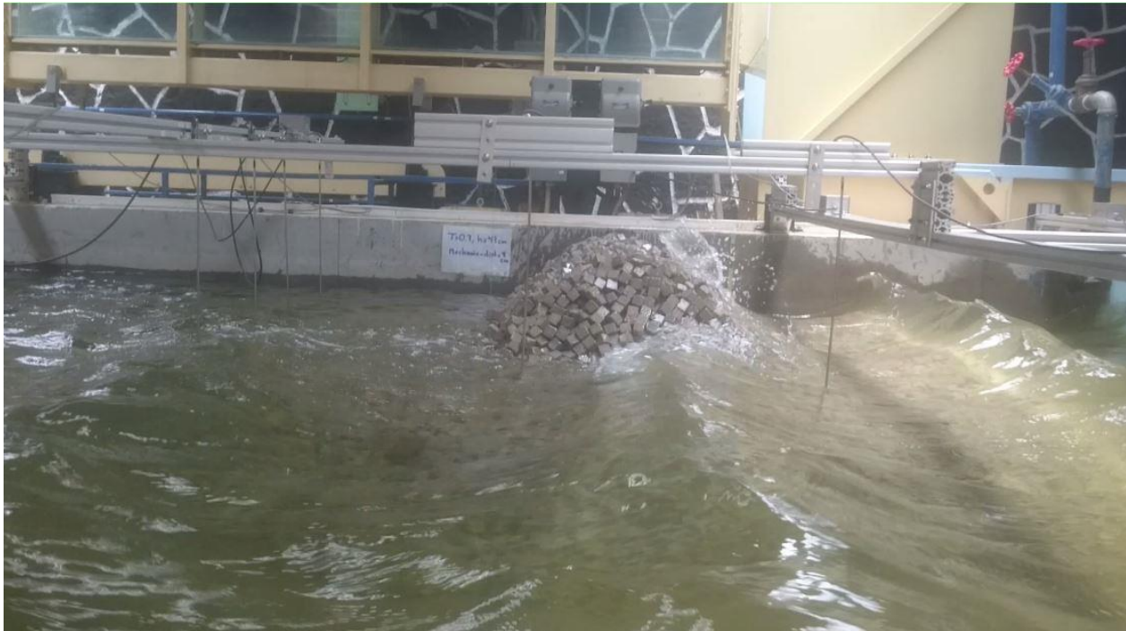
Figura 3.28 Fuerte rotura del oleaje y pérdida de algunas piezas en la curvatura del morro
