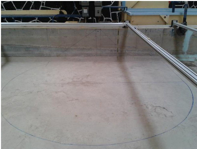
Figura 3.8 Trazo del dibujo del morro en la base del estanque de olas
