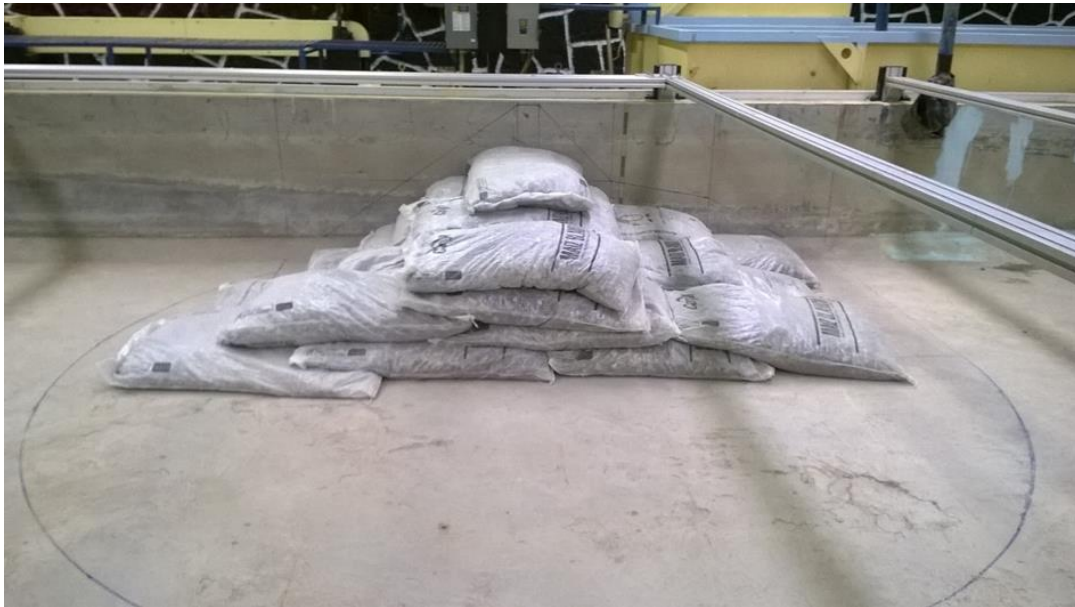
Figura 3.9 Construcción del núcleo del morro
