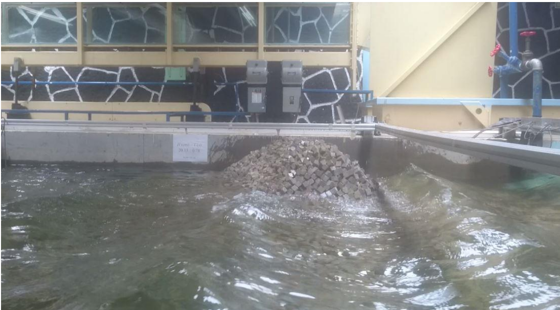
Figura 3.29 Alta estabilidad del morro girado para el oleaje más fuertemente observado durante los experimentos, con H = 9.91 cm, T = 0.78 s y h = 47 cm.
