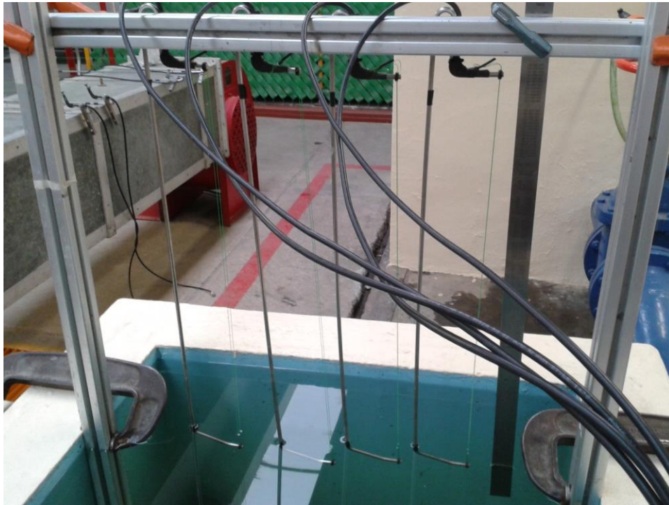
Figura 3.12 Cisterna pequeña perteneciente a uno de los modelos del laboratorio de hidráulica de la Facultad de Ingeniería, la cual se utilizó para la calibración de los sensores de nivel
