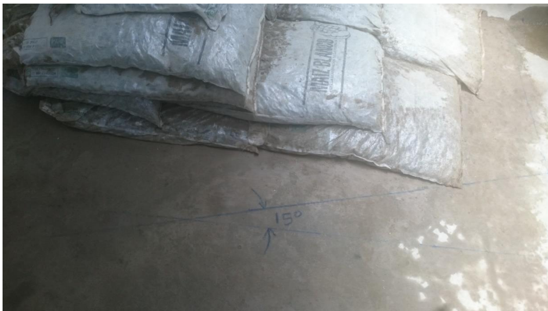
Figura 3.23 Trazo del dibujo del morro en el fondo del estanque de olas
