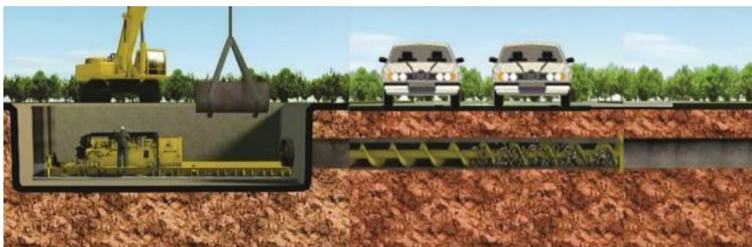
Figura 15 Método de perforación con tornillo sin fin. Fuente: perforacioneseingenieria.com (2000)
