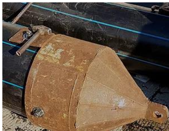
Figura 13 Cabezal de tiro y método de sujeción de la nueva tubería. Fuente: hperfora & company (1998)
