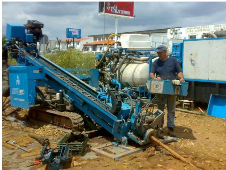
Figura 11 Maquinaria para perforación dirigida. Fuente: hperfora & company (1998)
