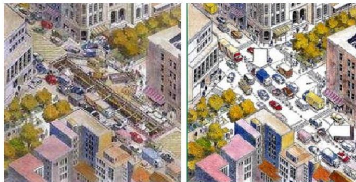
Figura 4 distintas afectaciones al entorno urbano por zanjas. Fuente: ICTIS (2012)
