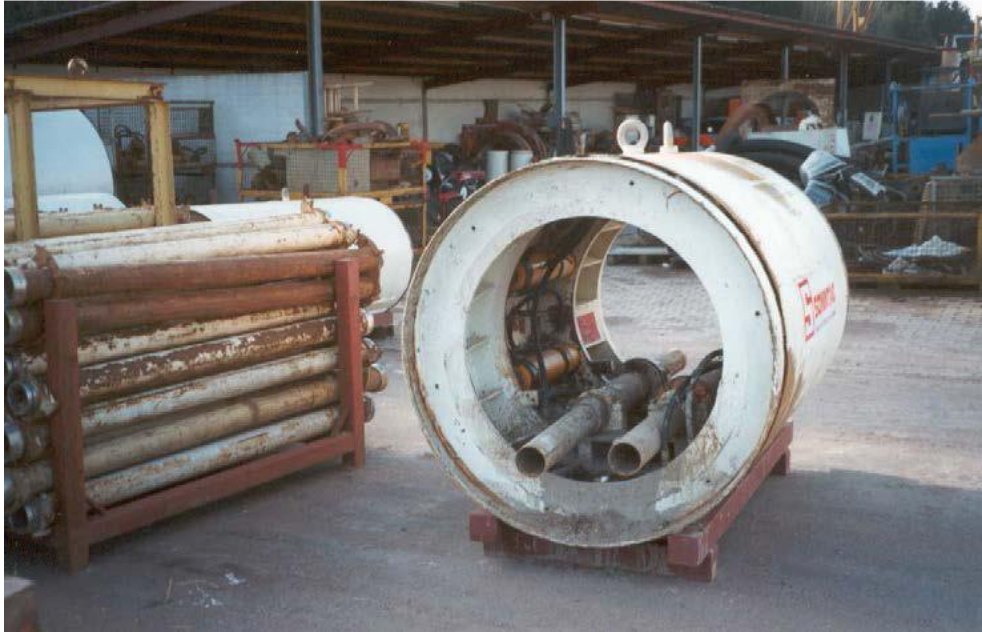
Figura 37 Estación intermedia de empuje. Fuente: (Pedraplus, I., 2014)
