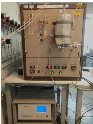
Figura 2.3. Sección frontal del sistema de reacción con chaqueta de calentamiento, salida de gases hacia detector de NO x .
