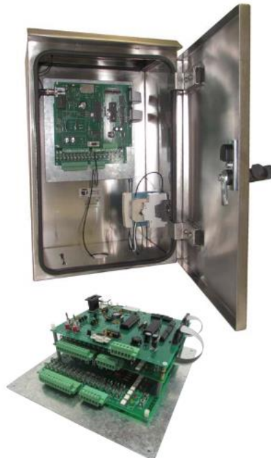
Figura 3.59. Controlador de semáforos con sincronía con detectores vehiculares y peatonales Fuente: (Trafitec, 2016)
