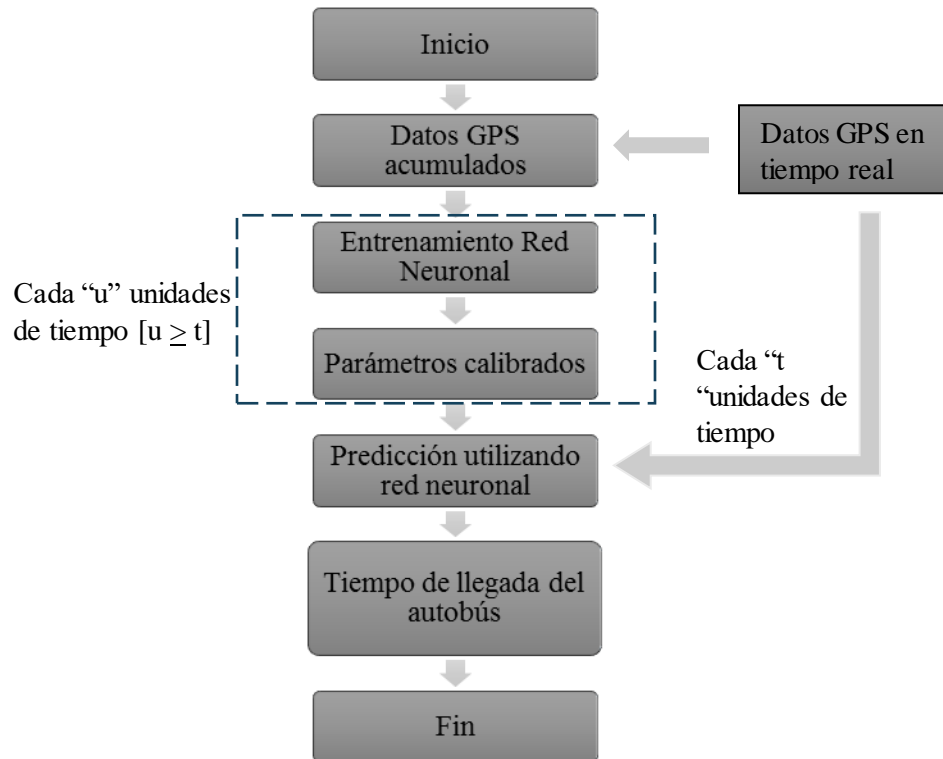
Figura 4.19. Proceso de actualización de parámetros en el modelo de predicción en tiempo real Fuente: (Hee, 2004)
