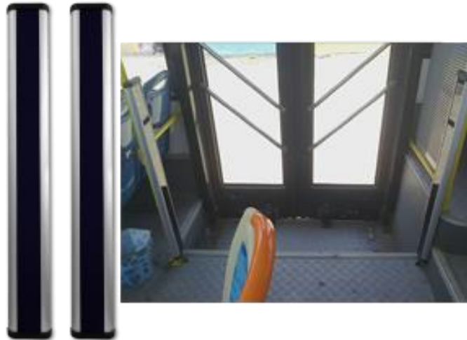
Figura 4.9. Contadores de pasajeros mediante infrarrojos Fuente: (Optimovilidad, 2017)
