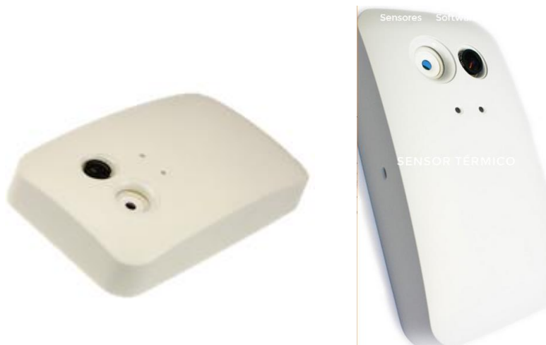
Figura 3.47. Sensores térmicos para conteo de personas Fuente: (Next Points, 2016 y Sigma, 2016)
