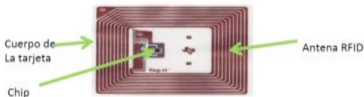
Figura 3.1. Componentes del tag o etiqueta Fuente: (Intermec, 2007)
