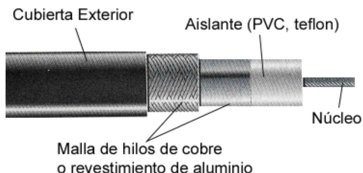
Figura 3.33. Cable coaxial Fuente: (Vargas, 2013)
