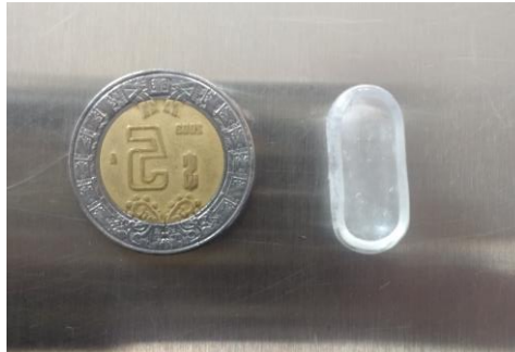
FIGURA 11 CÁPSULA DE CUARZO UTILIZADO PARA LA MEDICIÓN DE CARBONO ORGÁNICO Y CARBONATOS EN LAS MUESTRAS.
