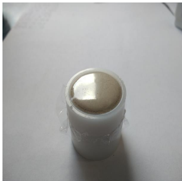
FIGURA 7 FOTOGRAFÍA DE UNA MUESTRA MOLIDA Y SECA EN UNA CÁPSULA DE PLÁSTICO PARA SU ANÁLISIS POR FRX.
