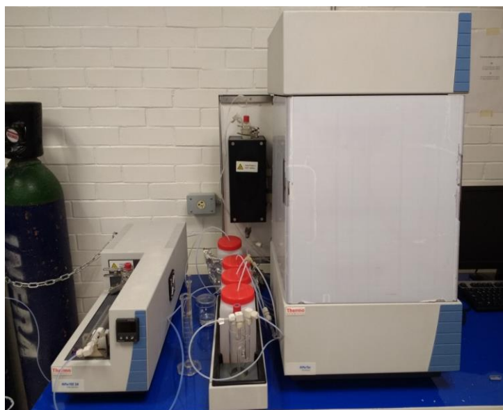
FIGURA 10 FOTOGRAFÍA DEL EQUIPO THERMO SCIENTIFIC MODELO HIPERTOUC UTILIZADO PARA LA ANÁLISIS DE CARBONO ORGÁNICO Y CARBONATOS.
