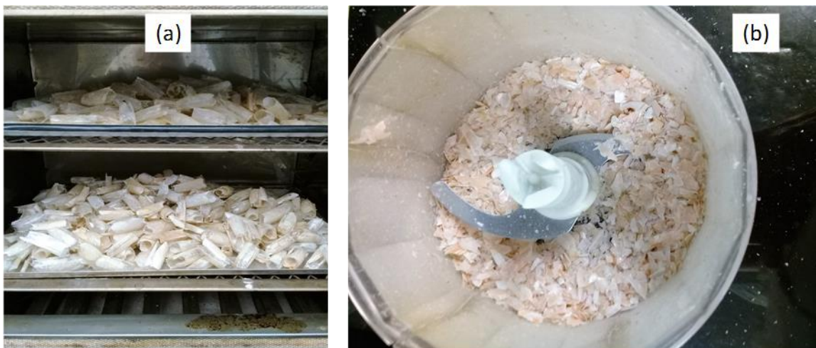
Fig. 2.1 Secado de cabezas de camarón limpio (a). Molienda de la cabeza limpia de camarón (b).
