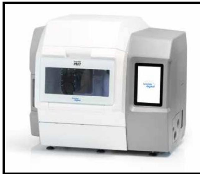
Figura 13 Equipo de 5 ejes (Progra Mill PM7).<sup>20</sup>
