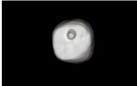
**Figura 5** Núcleo de Zirconia presinterizada. <sup>11</sup>
