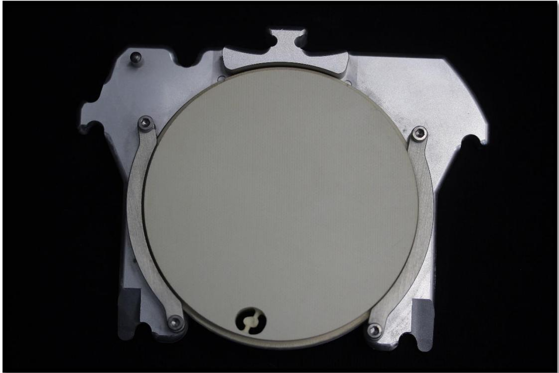
**Figura 31** Restauración intraconducto e intracoronaria fresada en disco Trilor®. F.D.
