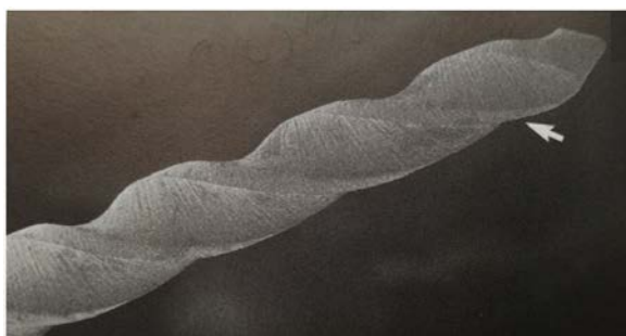
Fig. 8 Superficie radial de una lima señalada por una flecha. 1
