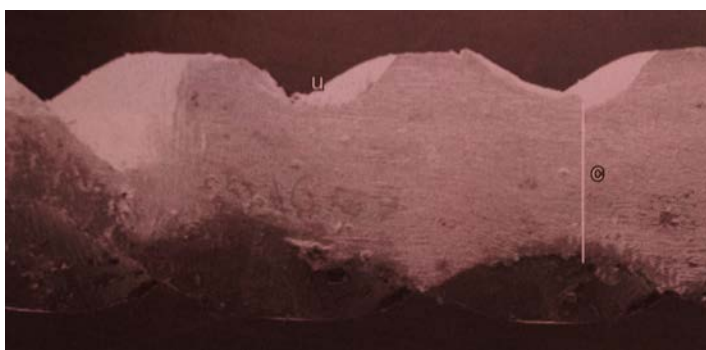
Fig. 6 Micrografía electrónica de barrido que muestra las excavaciones (u) y la dimensión del centro (c) de una lima. 1
