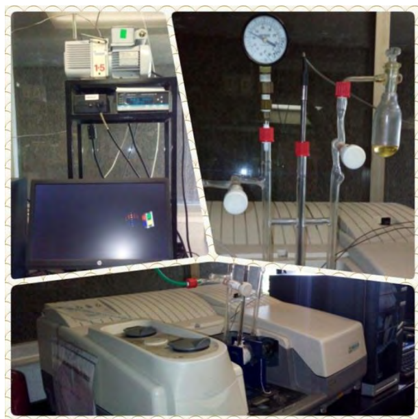
Figura 14. Espectrofotómetro Nicolet acoplado con un sistema para la impregnación de piridina
