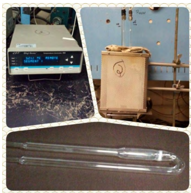
Figura 18. Horno, reactor de lecho fijo y controlador de temperatura donde se llevó a cabo la reacción de descomposición de metano
