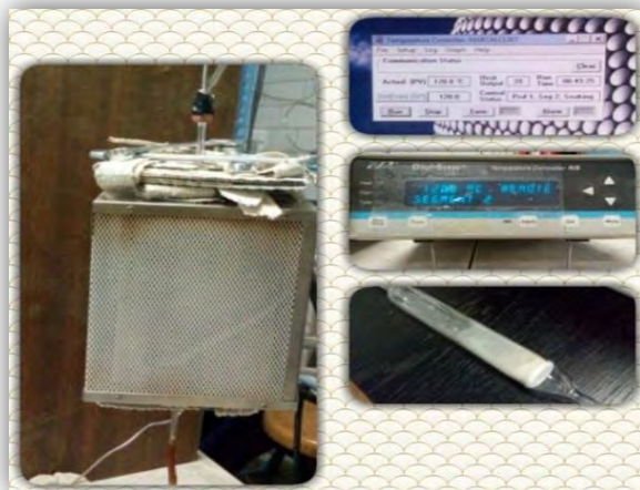
Figura 7. Horno, controlador de temperatura y reactor para llevar a cabo la calcinación y reducción
