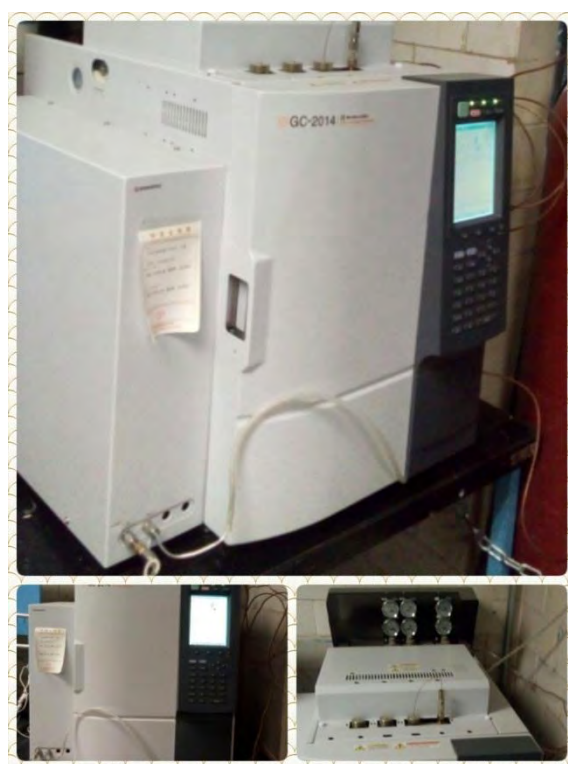
Figura 19. Cromatógrafo de gases Shimadzu GC-2014 donde se analizaron los gases obtenidos de la reacción
