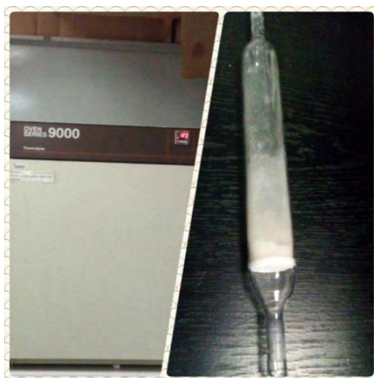
Figura 4. Estufa y reactor donde se llevó a cabo la calcinación
