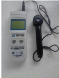
Figura 16. Radiómetro YK 35UV
