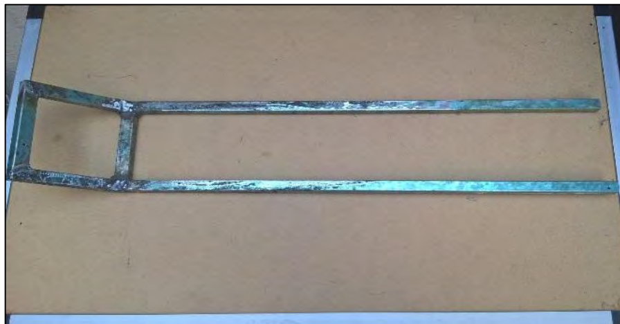
Figura 4.11 Estructura para la tapa del molde
