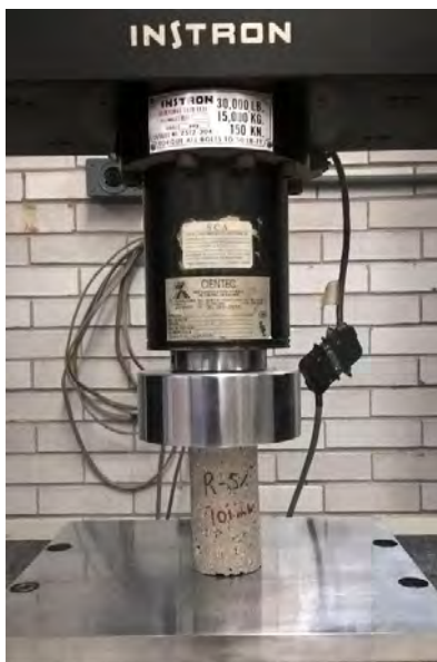
Figura 3.8 Ensayo de compresión para una de las probetas
