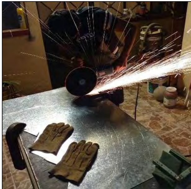
Figura 4.5 Corte de lámina galvanizada
