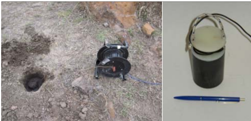
Figura 4-5. Electrodo EFP-06 y su disposición en campo.
