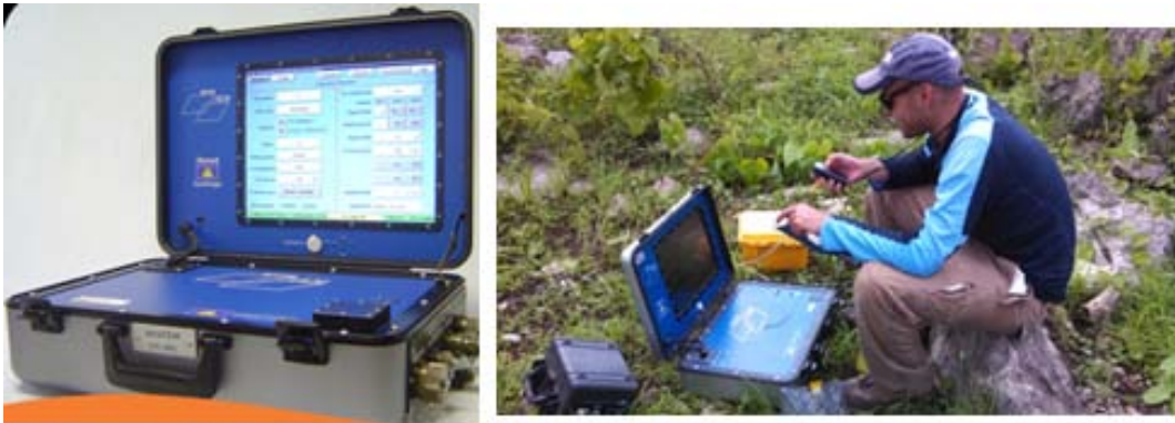
Figura 4-13. Equipo TerraTEM utilizado para la adquisición de datos.
