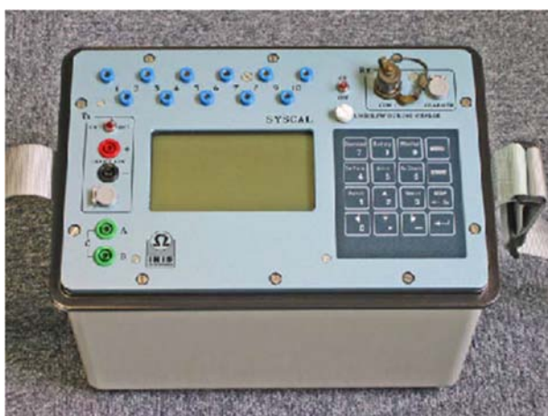
Figura 4-16. Consola del Resistivímetro Syscal – Pro Switch 48 (Iris Instruments).
