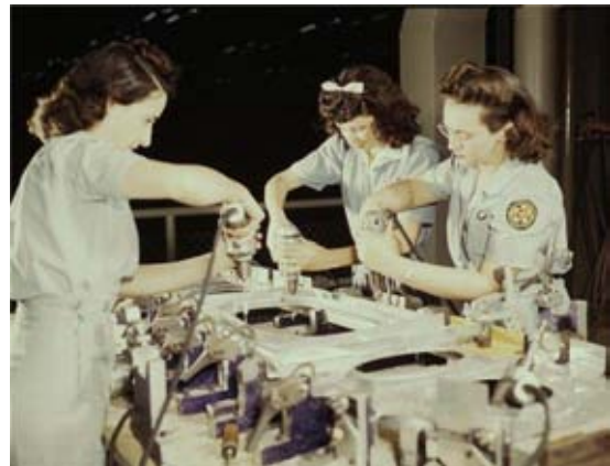
Perforando el tabique de una ala, en Fort Worth, Texas. Fotografía Howard R. Hallem en octubre de 1942.
