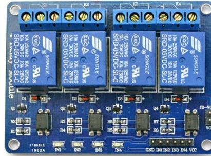
Figura 12. Módulo de relevadores
