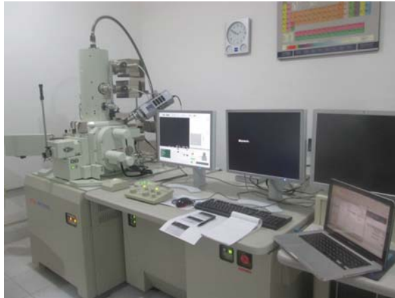
Figura 3.3. Sistema de caracterización física: SEM-EDS.
