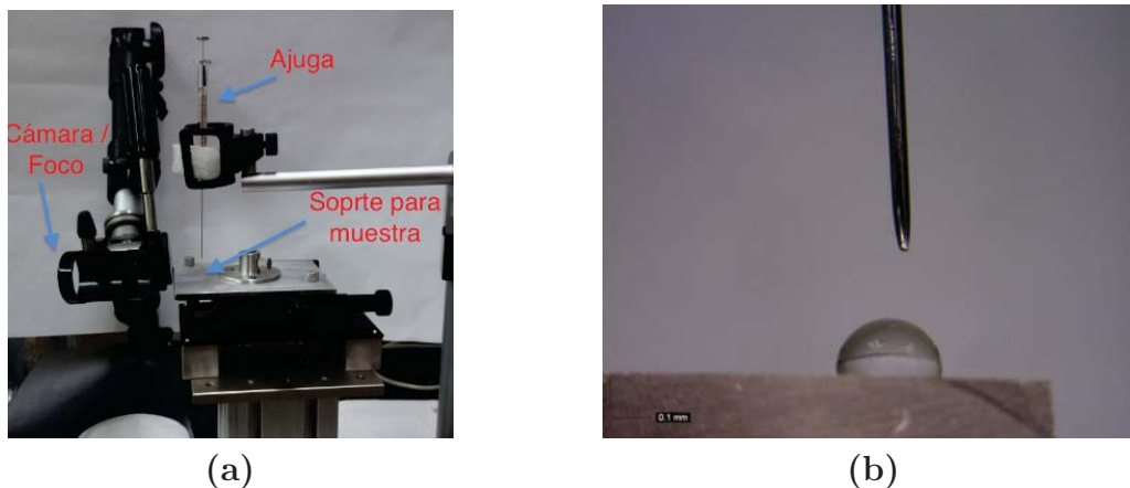
Figura 3.5. (a) Equipo para medición del ángulo de contacto, (b) resultado final visto desde la pantalla.
