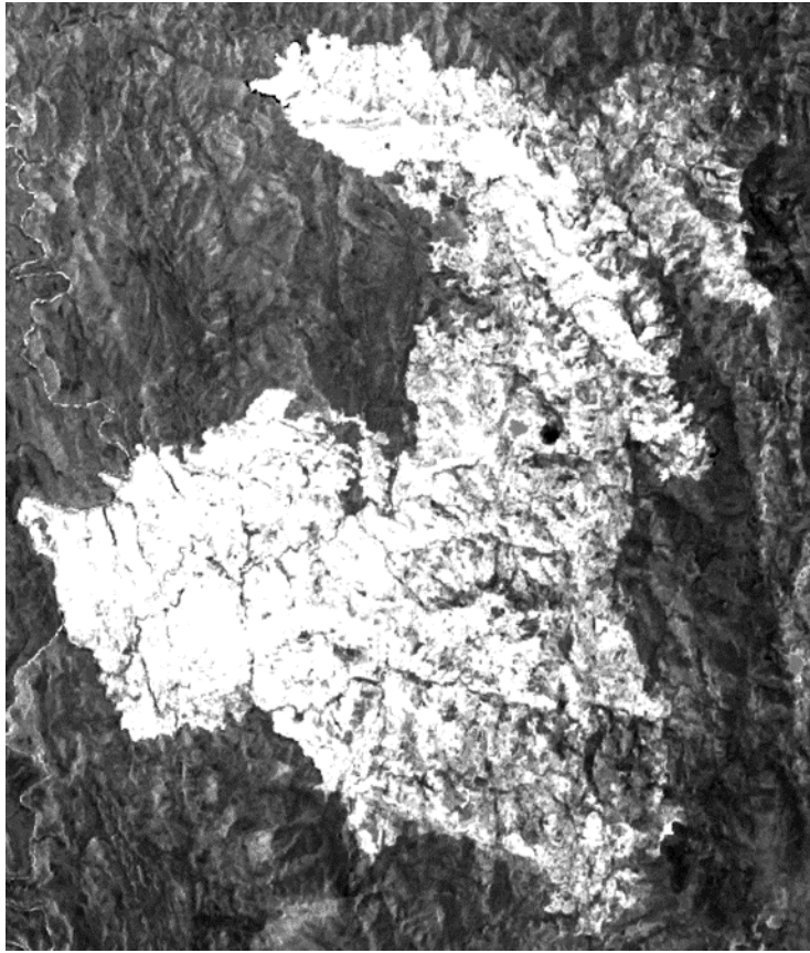
Figura 2.1. Algoritmo BAIM sobre la imagen Landsat-OLI del año 2014, para la discriminación de las superficies quemadas (zonas con mayor brillo) y no quemadas (zonas con menor brillo).
