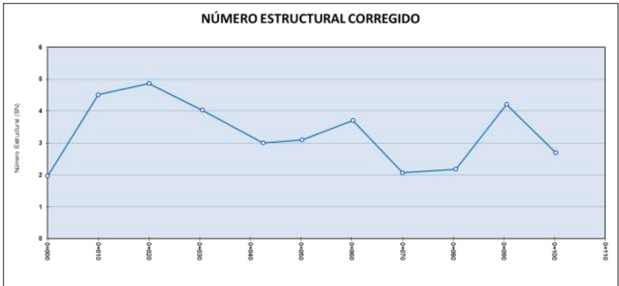
Gráfico 24. Número estructural (SN) del pavimento en la Plataforma VII - Derecho.
