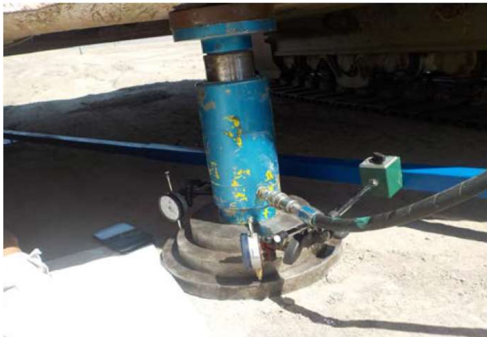
Imagen 11. Sistema implementado para la ejecución de las pruebas de placa.
