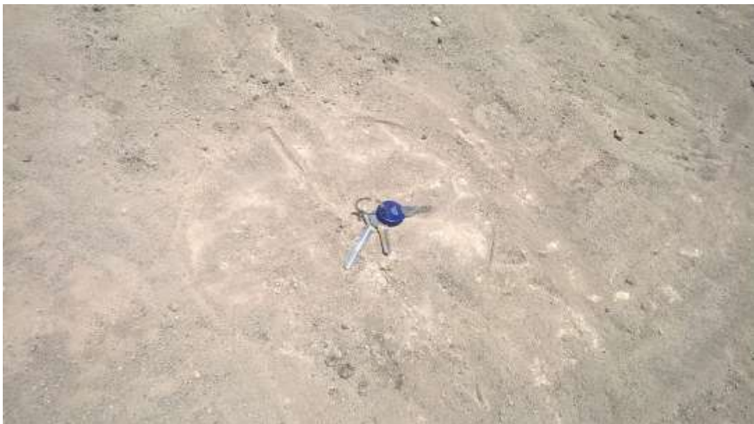
Imagen 13. Impresión de placa del FWD en (A) suelo natural y (B) en suelo mejorado con CaO.
