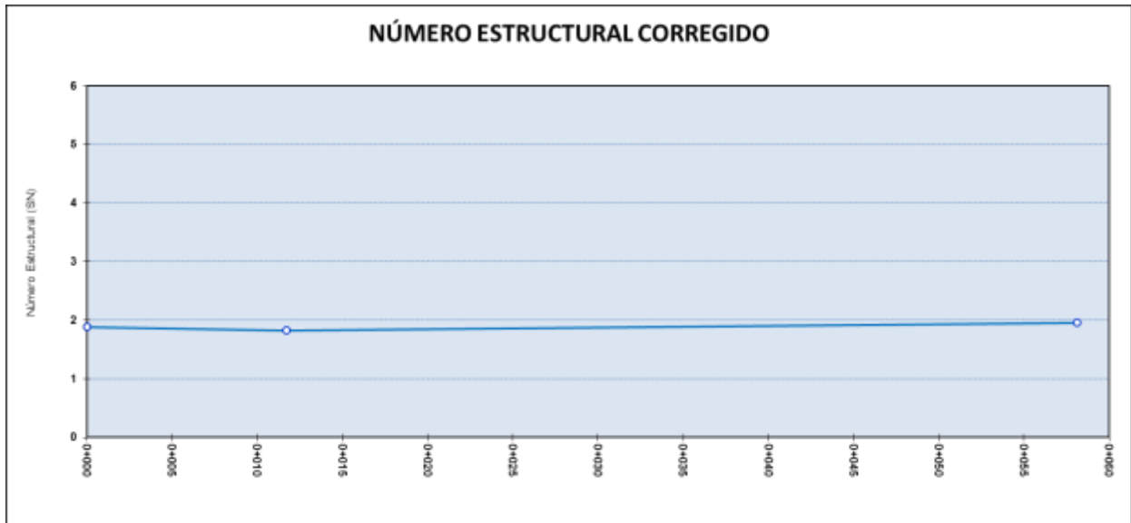
Gráfico 22. Número estructural (SN) del pavimento en la Plataforma VI
