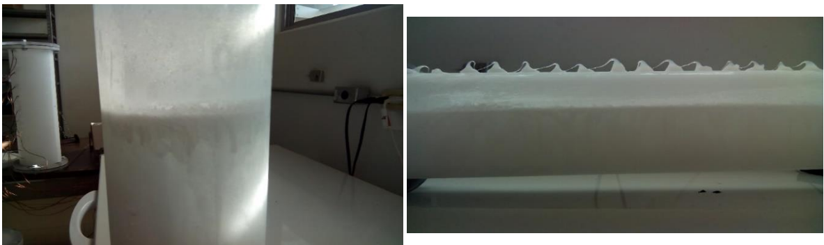
Figura 88 Aspecto hielo congelado, experimento sin recubrimiento a -30^{\circ}\text{C}
