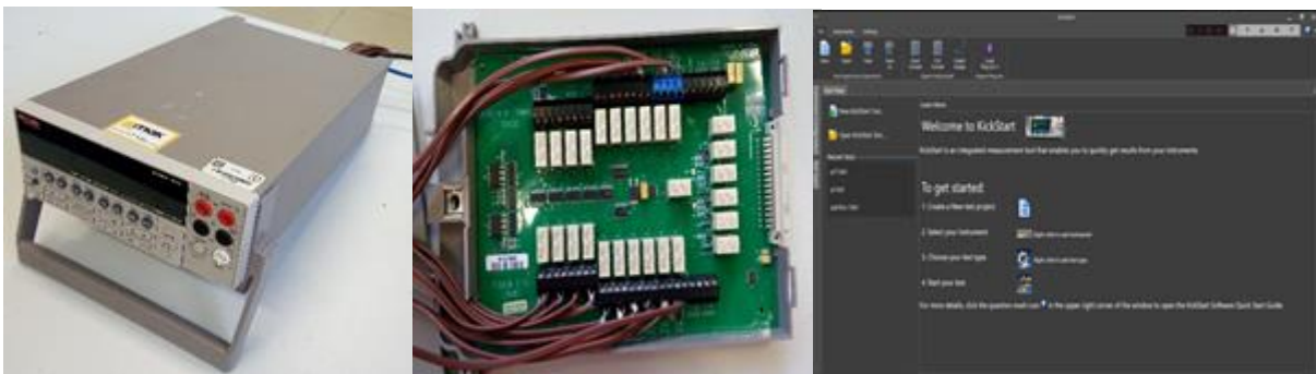
Figura 51 Equipo para medición de temperaturas
