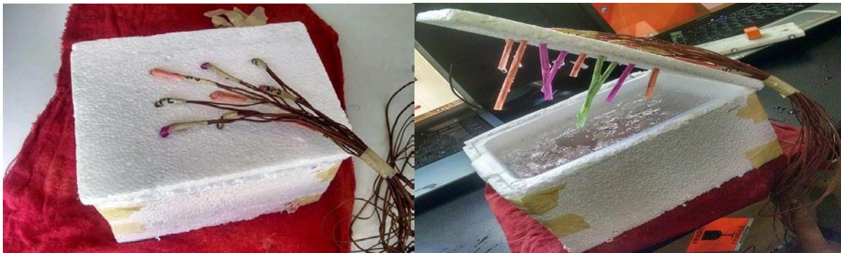
Figura 66 Aislamiento excepto inferior del contenedor
