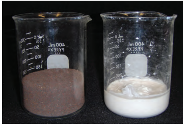
Fig. 2 Morteros para repellado: tezontle e hidróxido de calcio.
