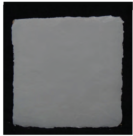
Fig. 13 El enlucido se dejó fraguar durante un día debido a su grosor
