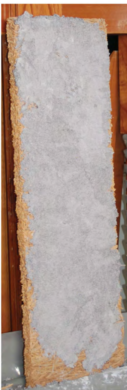
Fig. 25. La capa del repellado quedó bastante porosa, ideal para aplicar posteriormente el enlucido
