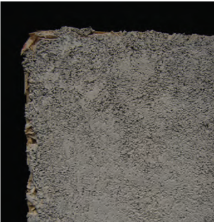
Fig. 8 Detalle de repellado seco. Se nota la porosidad en la superficie, que facilitó la adhesión del enlucido
