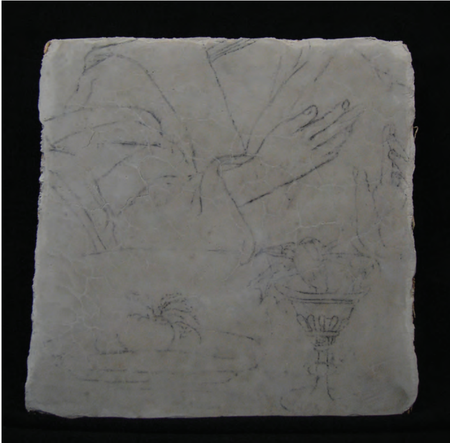
Fig. 16 Un día después se realizó el bruñido, esta vez se aplicó más fuerza sobre el enlucido lo que provocó mayor brillo, una superficie más tersa y se generaron múltiples grietas. Se notó un cambio en la tonalidad del enlucido
