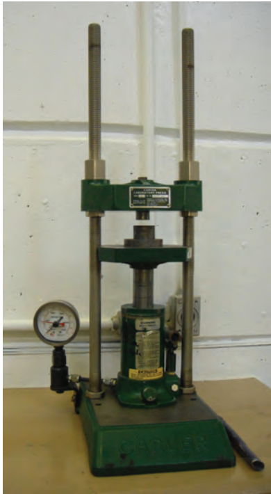
Fig. 87 Prensa hidráulica de 10 ton, aquí se molieron todos los morteros
