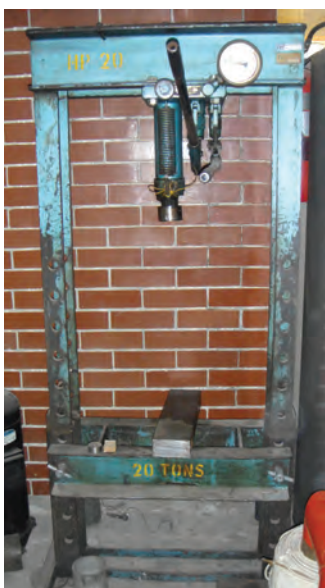
Fig. 85 Prensa hidráulica de 20 ton , en ésta se molió la obsidiana
