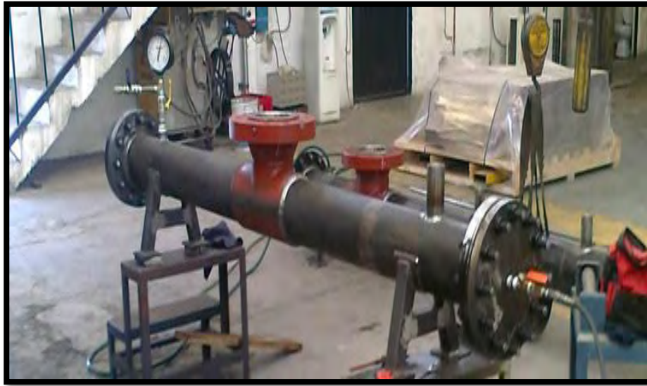
Imagen 9. Arreglo de una tubería para hacer prueba con agua.
