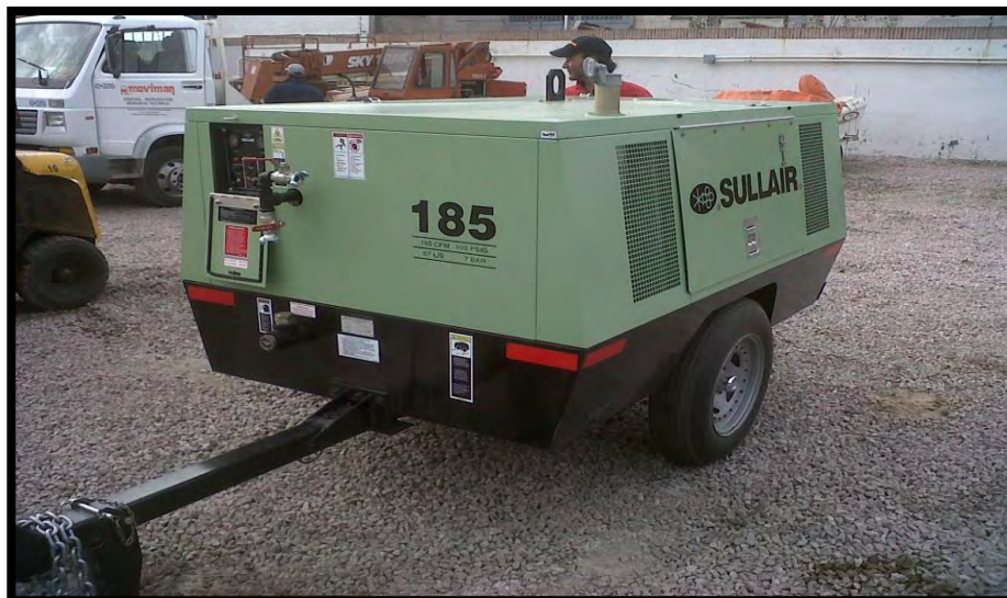
Imagen 21. Compresor para realizar el barrido de la tubería.
