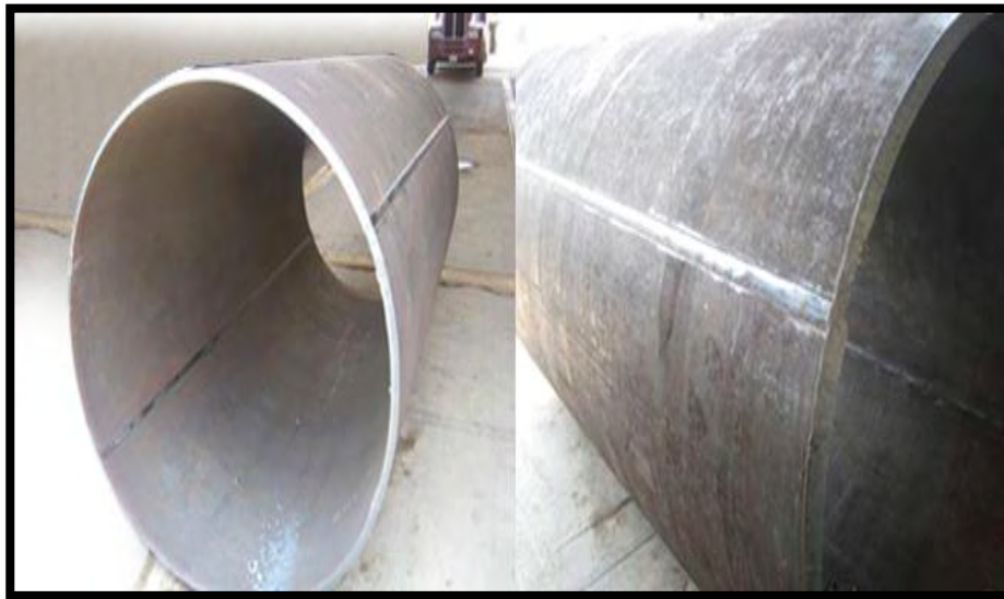
Imagen 14. Tuberías de acero al carbón con costura.
