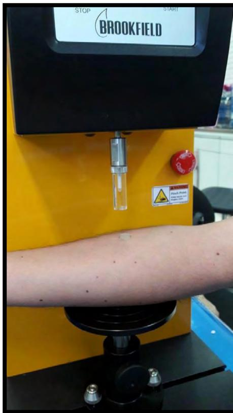
**Figura 31. Evaluación de la bioadhesión de los parches transdérmicos realizada en el texturómetro Brookfield CTB Texture Analyzer**
