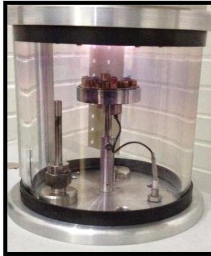
**Figura 27. Recubrimiento de las muestras mediante la técnica de “sputtering”**
