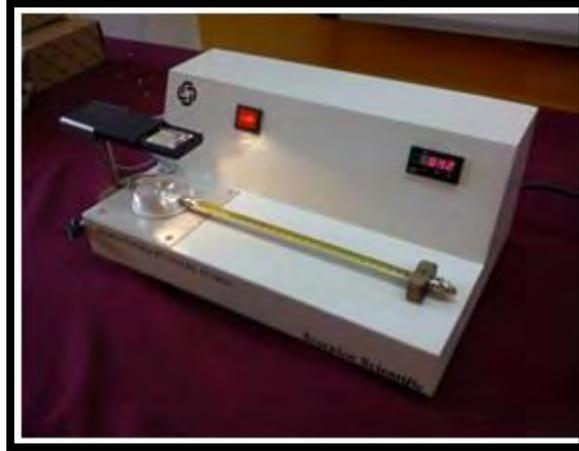
Figura 29. Aparato para determinar el punto de fusión <sup>70</sup>
