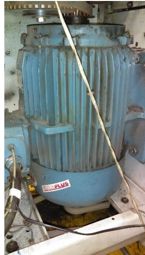
Ilustración 6 y 7. Detalle del motor eléctrico usado en las máquinas de torcido. Fuente: Elaboración Propia
