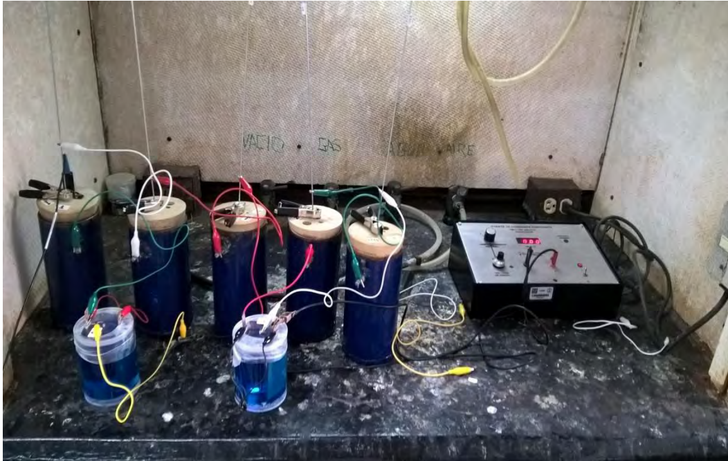
Figura 11: Sistema para medir la eficiencia de ánodos de Magnesio según la norma ASTM G-97-97(2002)
