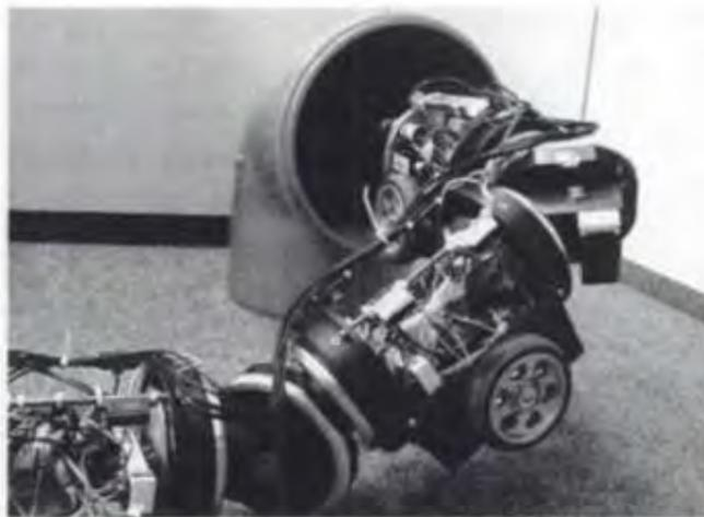
*Figura 2.11: MAKRO, robot móvil articulado de GMD (Alemania)*
