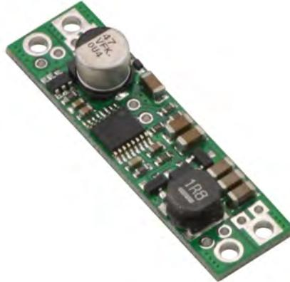
Figura 3.8: Regulador de Voltaje 5 V
