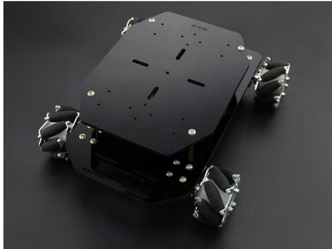
*Figura 2.9: Configuración Omnidireccional*
