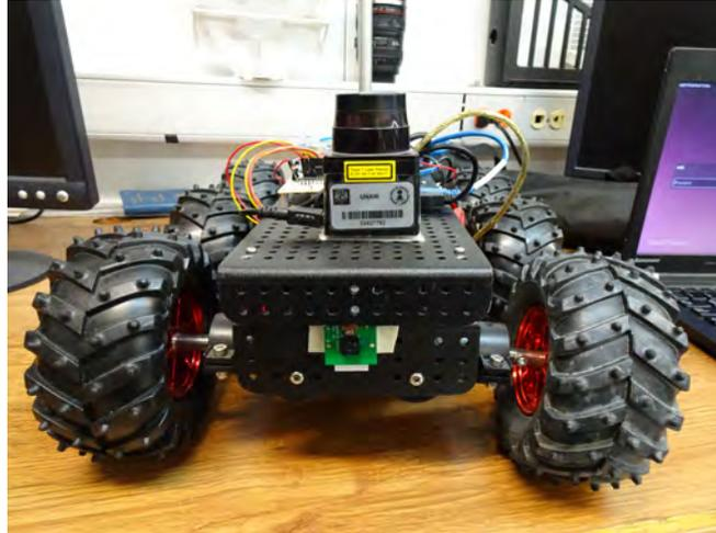
*Figura 4.2: Raspberry Pi Cam y el láser Hokuyo*
