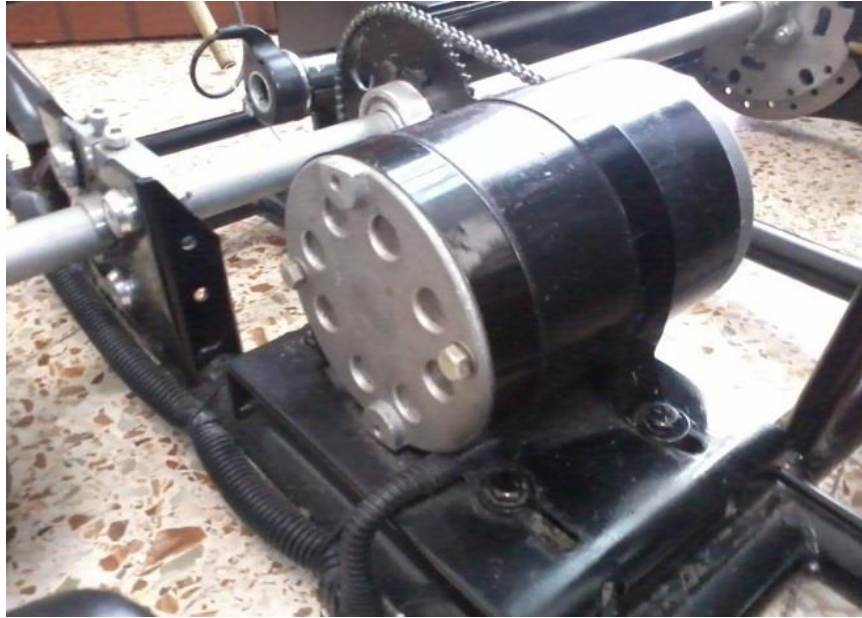
Fig. 4.8 Fijación de motor eléctrico al chasis.
