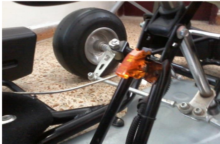
Fig. 4.12 Colocación de switch de encendido.
