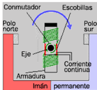
Fig. 1.9 Esquema de un motor a colector elemental.
