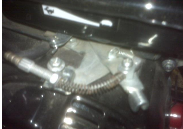
Fig. 4.2 Desconexión de chicote de acelerador.
