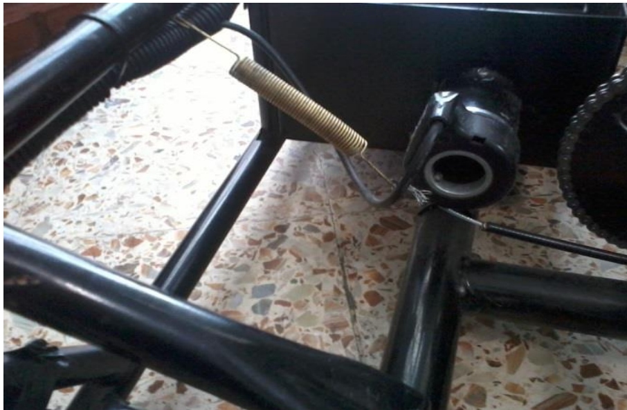
Fig. 4.10 Colocación de resorte metálico a puño del acelerador.
