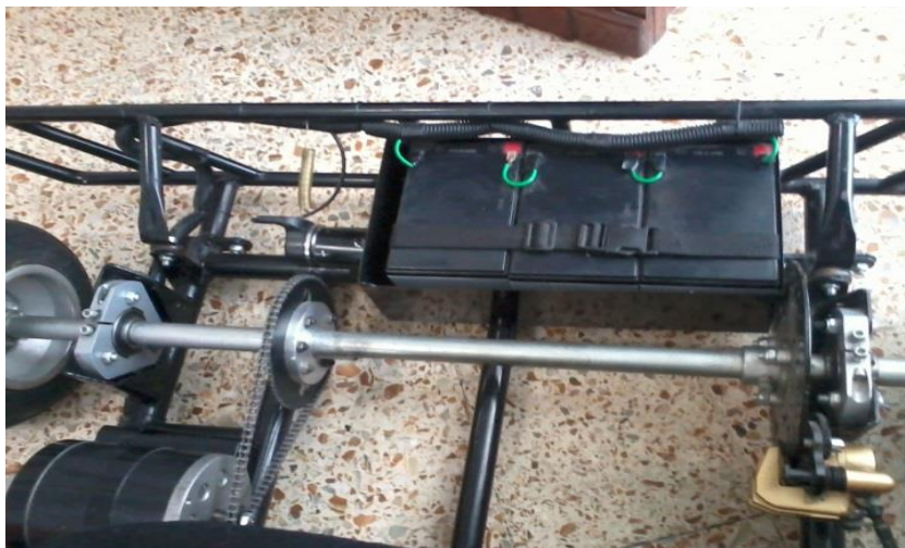
Fig. 4.9 Colocación de baterías.
