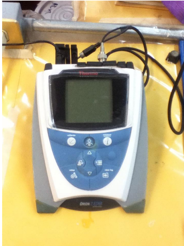
Figura 31: Potenciómetro para determinación de pH
