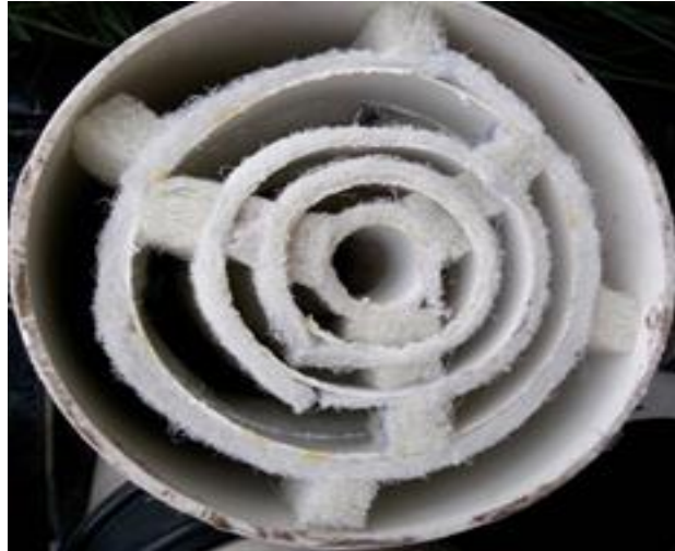
Figura 6: Estructura de fibra no tejida dentro del reactor tubular de biopelícula.
