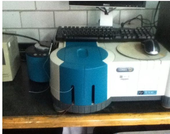
Figura 29: Espectrofotómetro Cary 50 para la determinación de nitratos y nitritos
