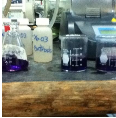
Figura 28: Determinación de Nitrógeno Amoniacal
